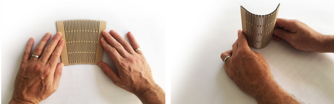
Principe du Lattice Hinge ©ArtBuild Maquette en MDF 8 mm d'épaisseur.
