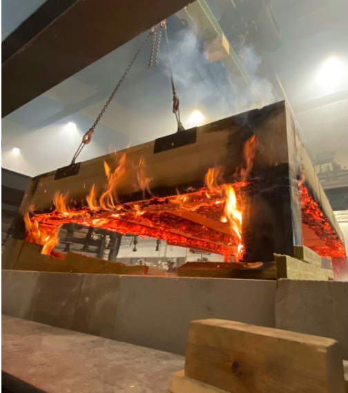
Image 3 : Essai de résistance au feu d'un module de plancher – Hortus, Basel
