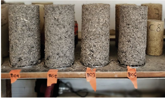
Figure 2 : Tests de dosages du mélange terre / fibre
