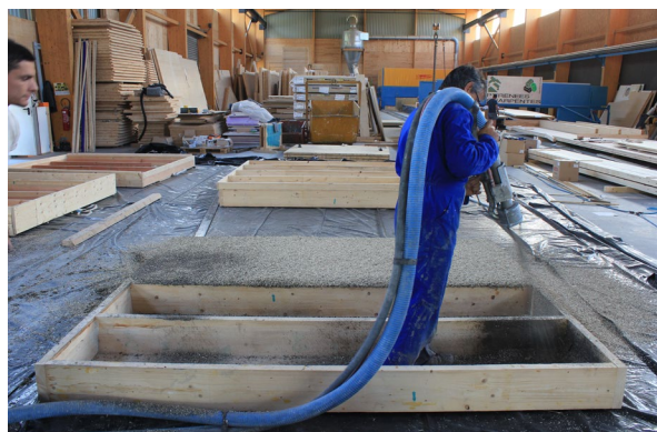
Figure 2 : Test de projection en atelier
