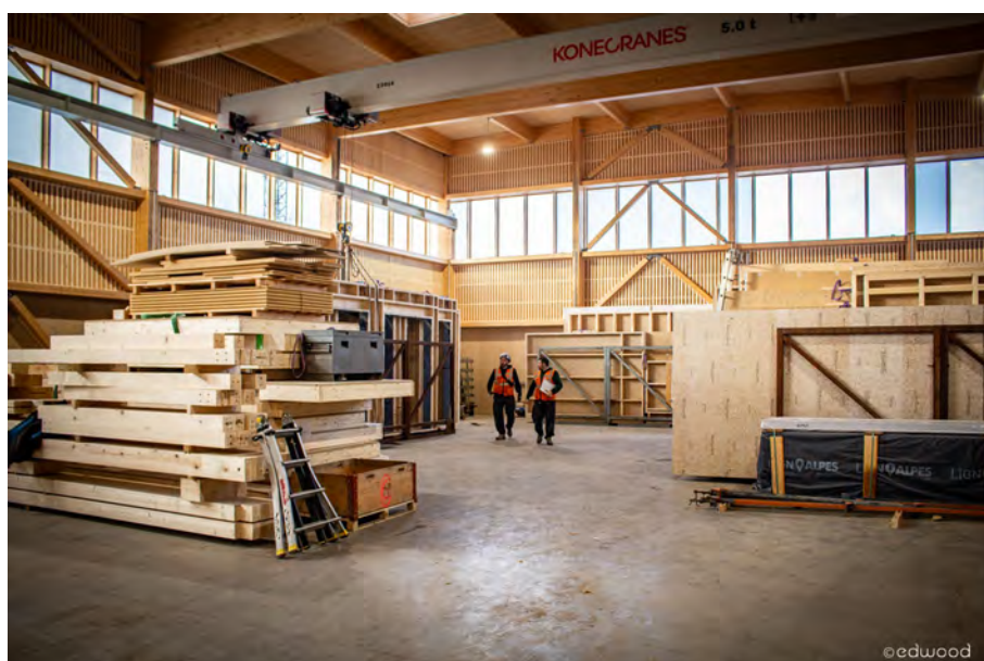
Le pont roulant couvre l'ensemble de l'atelier
