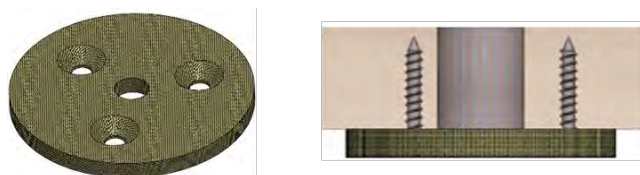
Image 4 : Illustration schématique de la rondelle EE située côté intérieur de l'assemblage
