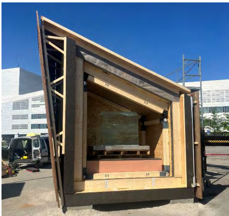
Image 7 : Une tonne de glace installée dans la IceBox passive démontable – Produktif®
