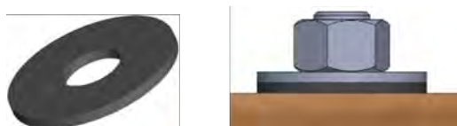
Image 3 : Illustration schématique de la rondelle E située côté extérieur de l'assemblage
