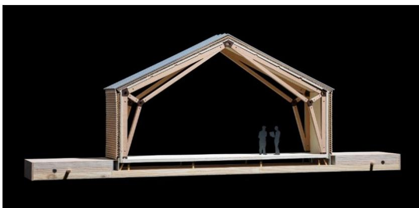
Abbildung 11: Detailmodell Werk- und Forschungshalle: Kriechkellerkonstruktion.
