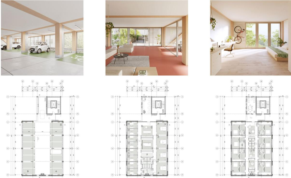
Abbildung 4: Umsetzung der Ausbaustufen Parken, Arbeiten und Wohnen, t-lab [1]
