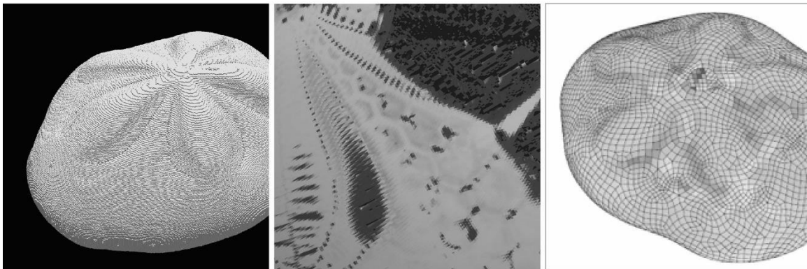
Abbildung 3: Analyse des Schalenskeletts. Links: Voxelmodell eines CT-Scans. Mitte: Dichtevariation der Schale bei der sich die Plattenränder abzeichnen. Rechts: Übertragung in ein FE-Modell der Schale.
