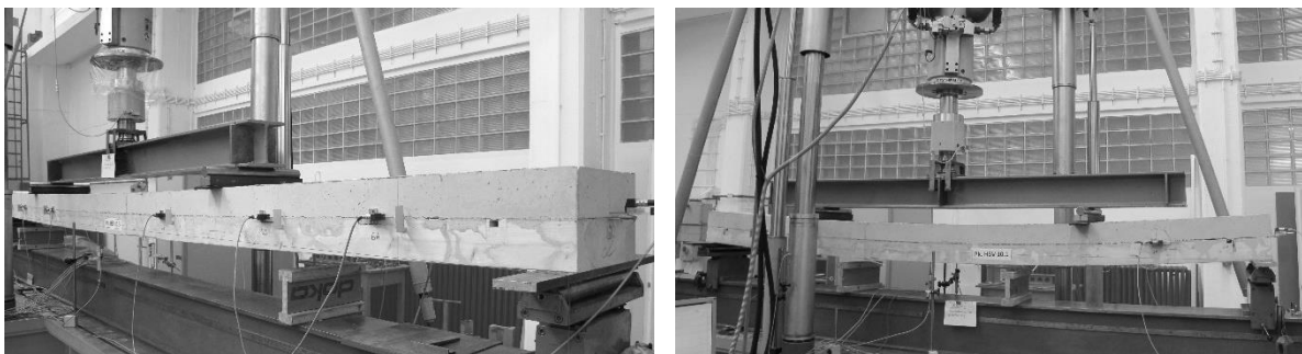
Abbildung 2.8: Biegeträger mit 6 Kerven (links) und Schubträger mit 2 Kerven (rechts)
