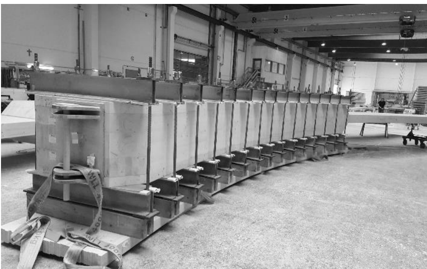
Abbildung 8: Mactan Cebu Airport, Blockverleimung zweiter Arbeitsvorgang, Foto: RUBNER Holzbau
