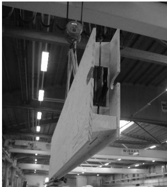
Abbildung 10: Gerades Träger-„Stück“ im 3-m-Raster. ©WIEHAG
