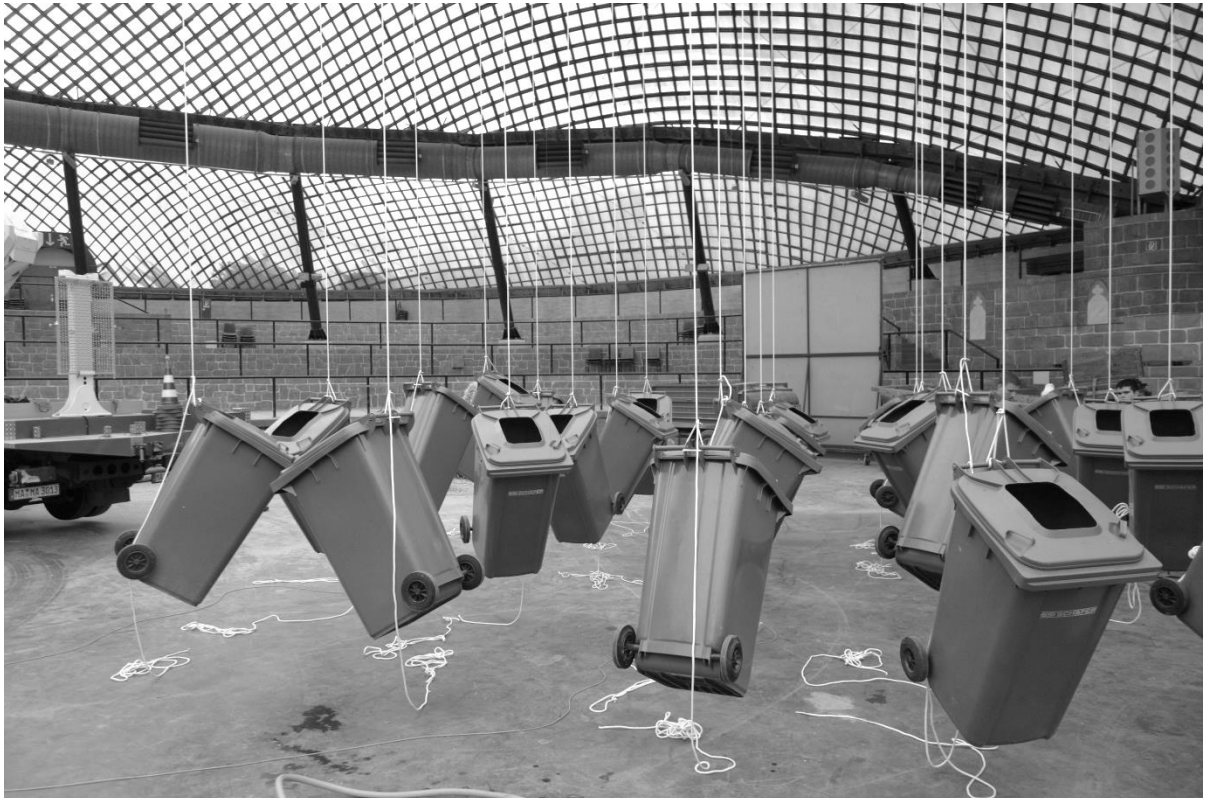
Abbildung 7: Belastungsversuche mit Mülltonnen heute wie damals.
