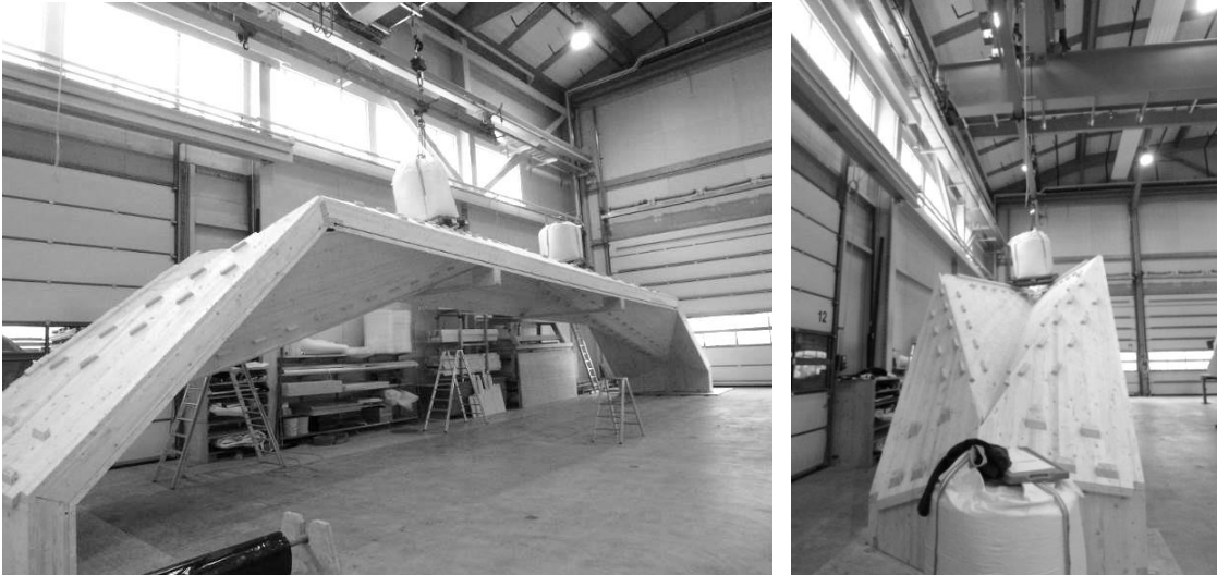
Abbildung 9: Belastungstest des ersten Dachelements mit Gewichten
