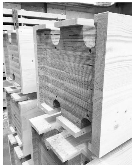
Abbildung 9: Stützenquerschnitte optimiert auf die Einwirkungen. Bei den am grössten belasteten Stützen kam Baubuche zum Einsatz: Die Baubuchenstützen wurden mit BSH-Umleimern versehen, damit sie sich optisch nicht abheben.
