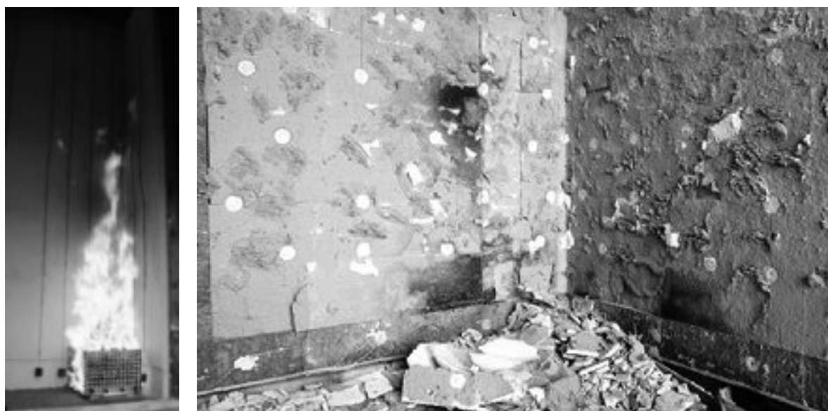
Abbildung 6: Holzfaser-WDVS während der Beflammung im Sockelbrandversuch (links); Nach Versuchsende geöffnetes System im Sockelbrandversuch, mit leichten Verfärbungen im Bereich der Holzkrippe (rechts)
