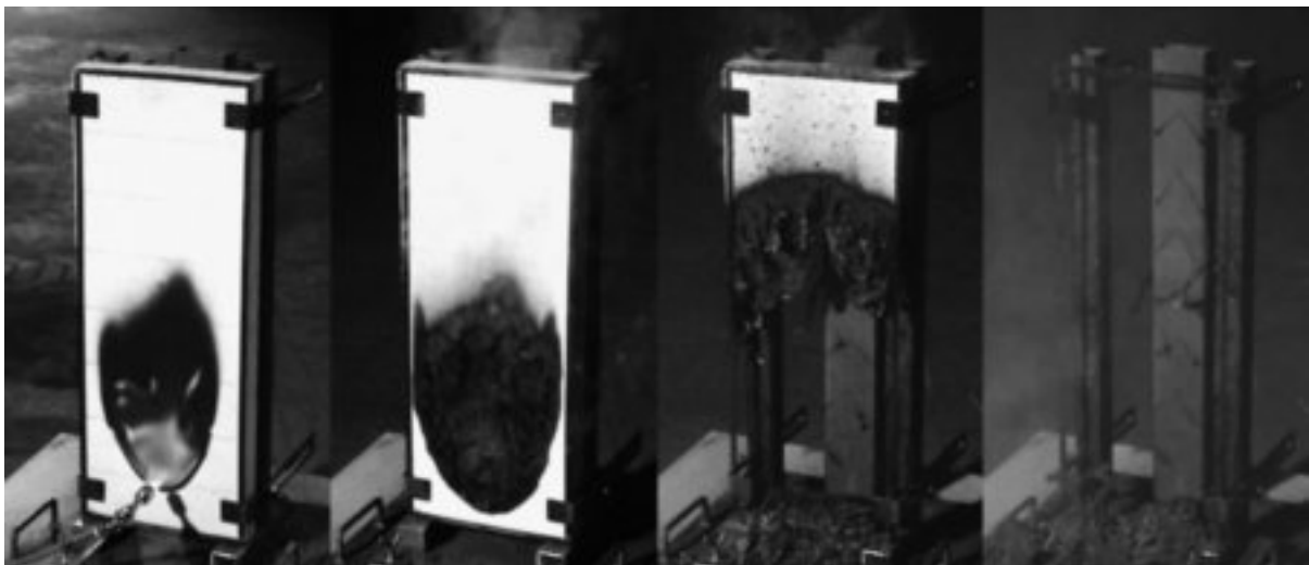
Abbildung 2: Verlauf einer Schwelprüfung nach DIN EN 16733 mit Holzfaserdämmplatten (v.l.n.r.) während der Beflammung, unmittelbar danach, sowie zwei und sechs Stunden nach der Beflammung
