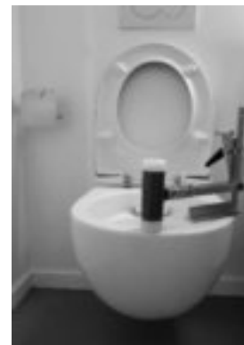
Abbildungen 6 – 8: Messung der Luft- und Trittschallübertragung sowie der Geräusche haustechnischer Anlagen
