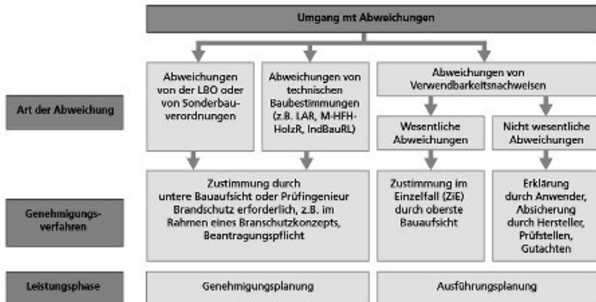
Abbildung 2: Abweichungen im Rahmen der Genehmigung und Ausführung (Bildquelle: Holzbau DeutschlandInstitut e.V.)
