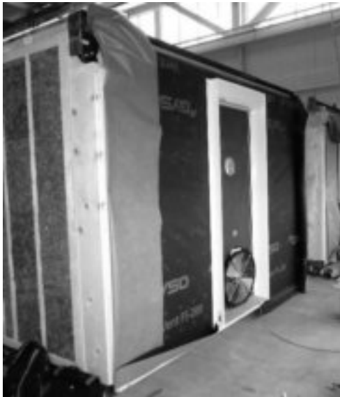
Abbildung 4: Blower-Door-Test am Modul
