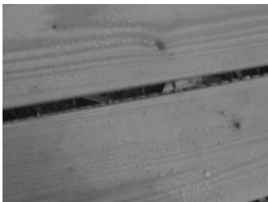
Abbildung 11: Hydrophobierte Holzproben auf dem Bewitterungsstand, ein Abperleffekt ist erkennbar, welche jedoch zeitlich begrenzt ist (Volkmer 2008)
