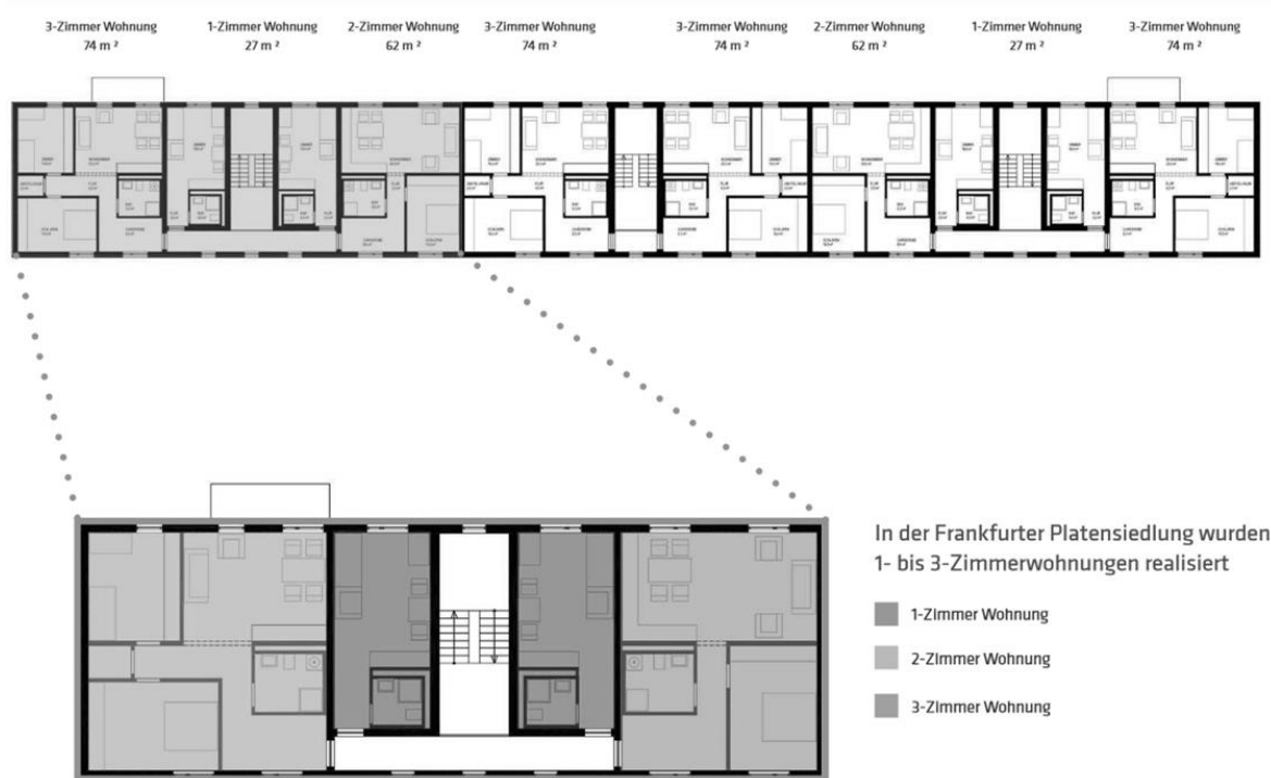
Abbildung 3: Grundriss eines Riegelbaus
