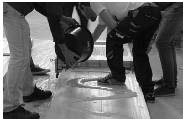
b) Grober Klebstoffauftrag vor der halbautomatischen Klebstoffapplikationsmaschine
