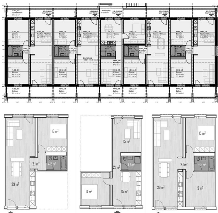
Abbildung 3: Grundrisskonzept: Drei Modultypen – frei kombinierbar.
