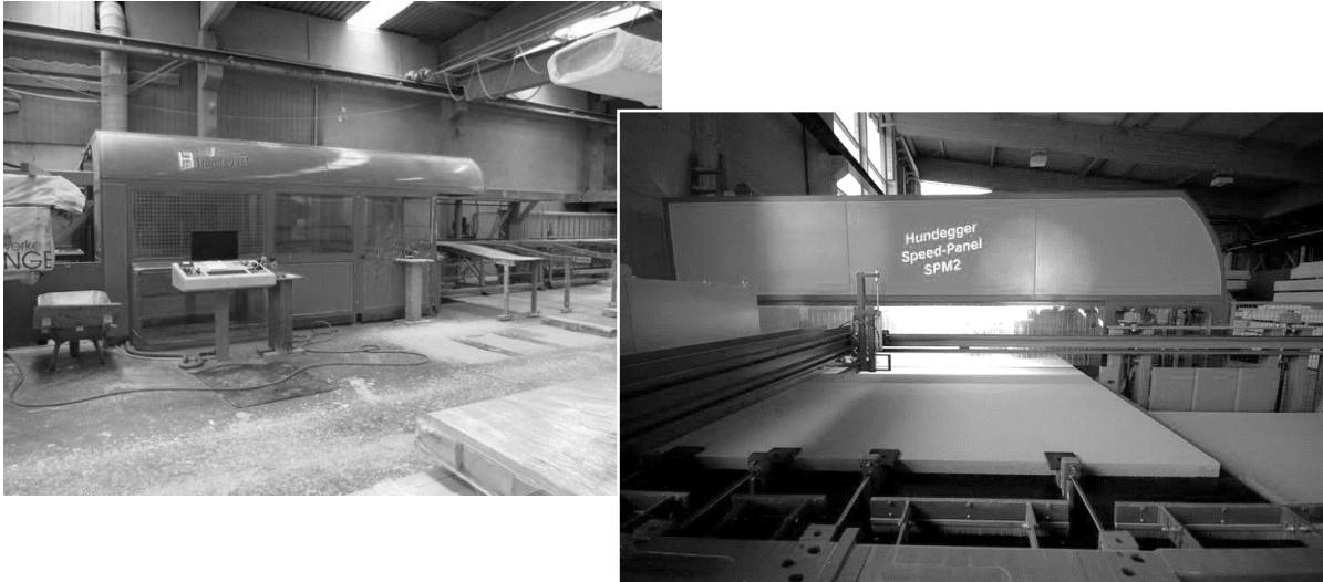
Abbildung 4: automatischer Zuschnitt von Stäben und Platten (Fotos: Prause Holzbauplanung, Holzbau Henz)
