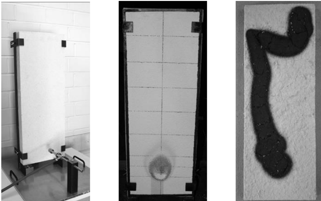
Abbildung 2: Holzfaserdämmstoff mit Putzschicht im Prüfstand nach DIN EN 16733 (beispielhaft)
