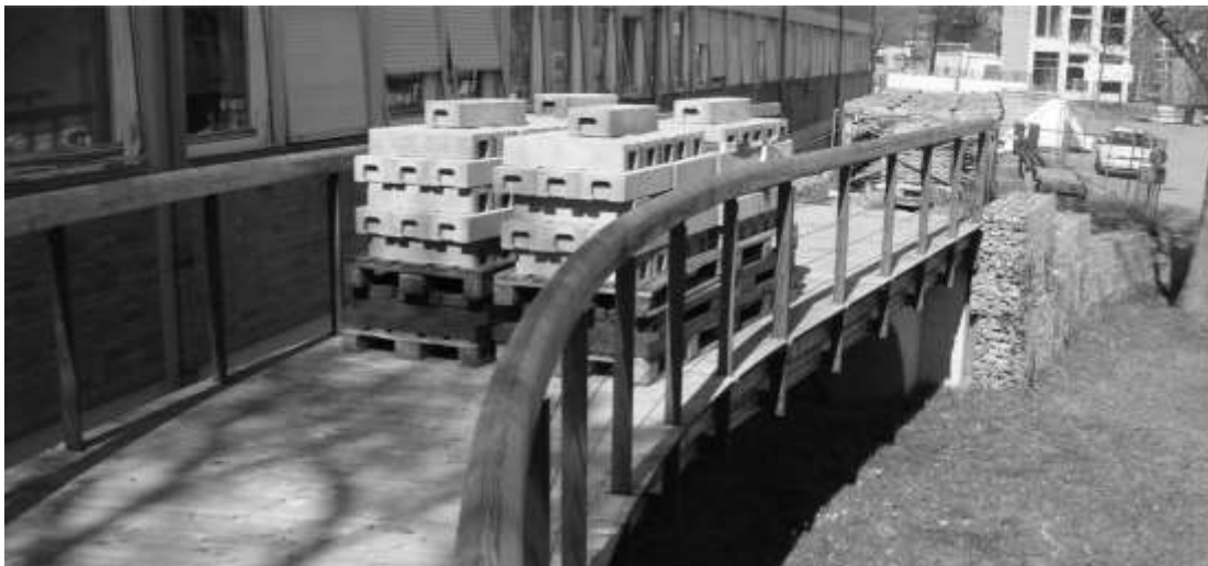
Abbildung 5: Ansicht der Lastanordnung der Langzeitversuchs mit 80 kN Lasteinwirkung in Feld 1
