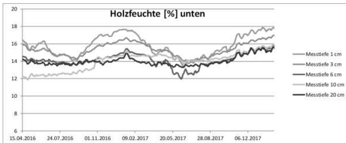
Abbildung 10: Darstellung der Holzfeuchteentwicklung in unterschiedlichen Messtiefen an der Unterseite des BSH-Verbundträgers
