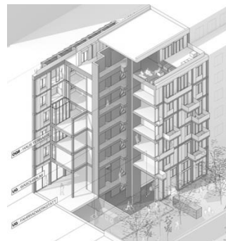
Abbildung 24: Skelettkonstruktion mit aussteifendem Kern
