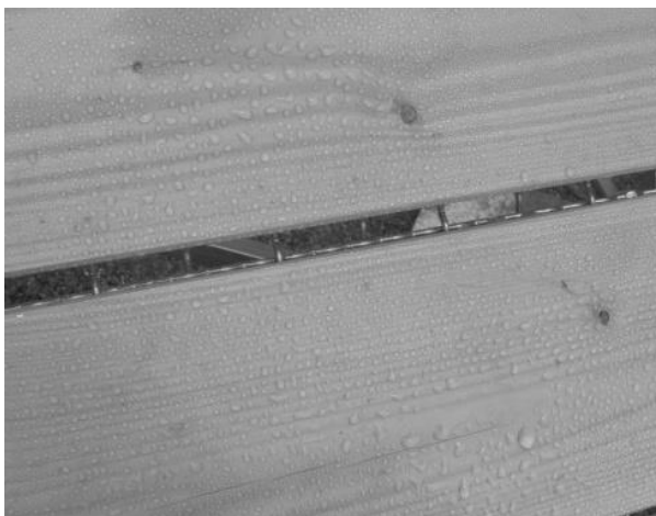
Abbildung 11: Hydrophobierte Holzproben auf dem Bewitterungsstand, ein Abperleffekt ist erkennbar, welche jedoch zeitlich begrenzt ist (Volkmer 2008)
