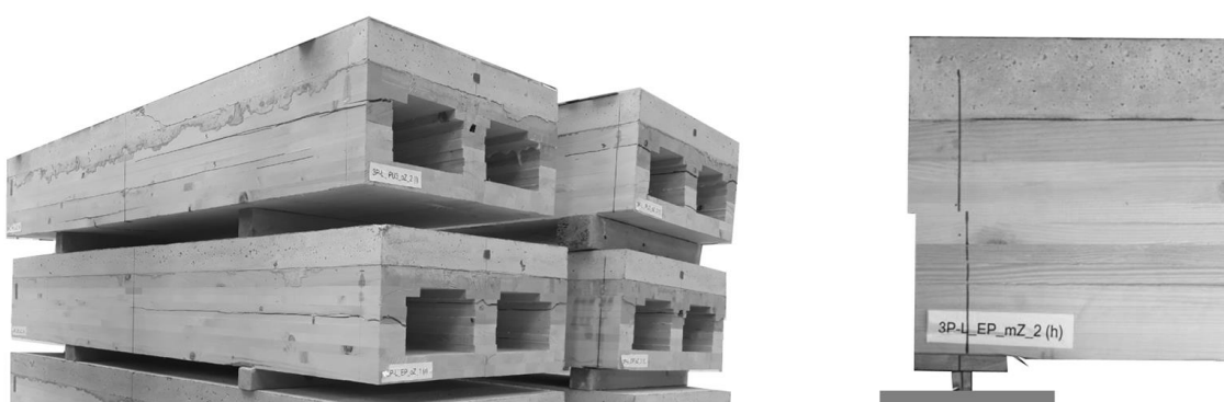
Abbildung 9: Kurze, gedrungene Lignotrend-HBV-Träger nach den Drei-Punkt Biegeversuchen zum Test der Schubtragfähigkeit: Immer Schubversagen im Holz der Stege
