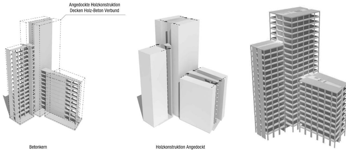
Primärtragstruktur mit Betonkern und angedockter Holzkonstruktion
