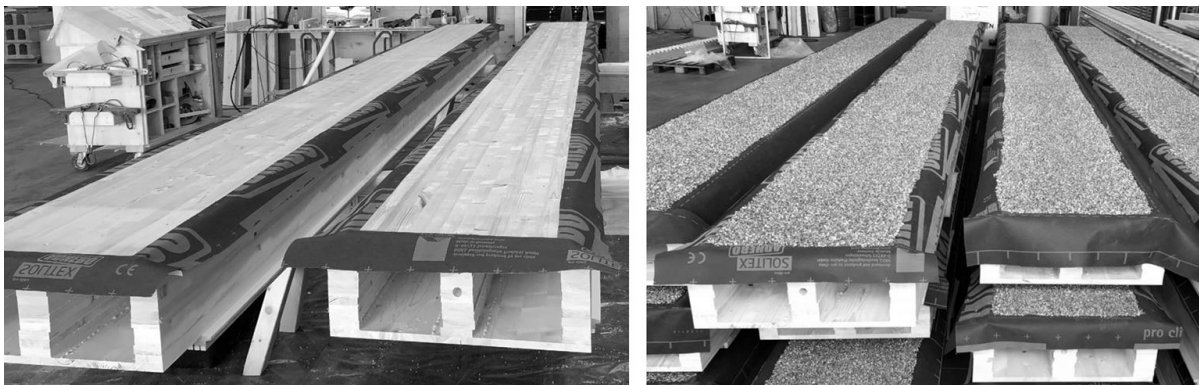
Abbildung 10: Fertigung: Lignotrend-Element vor und nach dem Auftrag der Splittverklebung © Lignotrend
