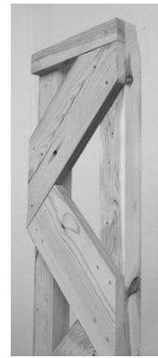
Abbildung 14: Fachwerkständer, Stäbe mit unterschiedlichen oder gleichen Querschnitten, exzentrisch montiert
