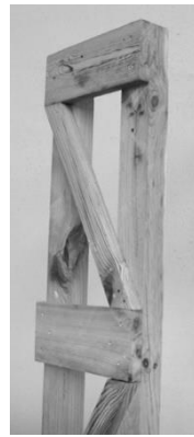
Abbildung 14: Fachwerkständer, Stäbe mit unterschiedlichen oder gleichen Querschnitten, exzentrisch montiert
