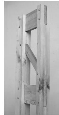
Abbildung 15: Fachwerkständer, Stäbe mit unterschiedlichen Querschnitten, zentrisch montiert
