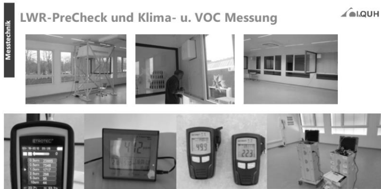
Abbildung 7: LWR – Luftwechselraten, Holzbau Messstudie in Schulräumen: Auswirkung von unterschiedlich grossen Lüftungsanlagen auf die Raumluftmesswerte (Risikominimierung durch Vermeidung von hohen Partikel-, VOC-, CO 2 -Werten).
