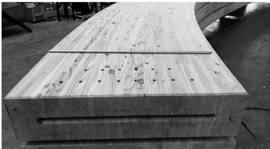
Abbildung 9: Vormontierte Bogenbinder in Doppelgebinden
