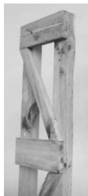
Abbildung 15: Fachwerkständer, Stäbe mit unterschiedlichen oder gleichen Querschnitten, exzentrisch montiert
