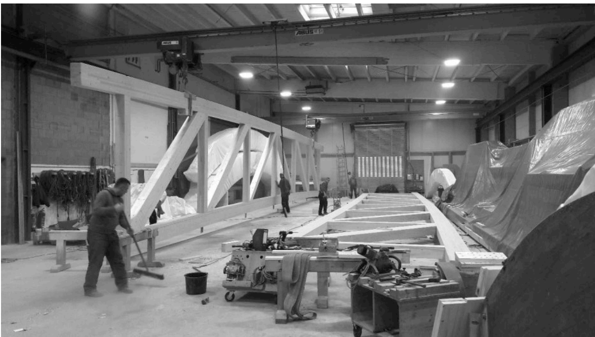
Abbildung 9: Vorfertigung der Fachwerkträger im Werk in Rosenheim
