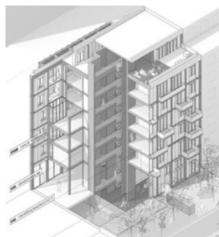
Abbildung 25: Skelettkon- struktion mit aussteifendem Kern
