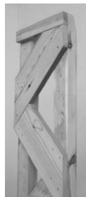
Abbildung 15: Fachwerkständer, Stäbe mit unterschiedlichen oder gleichen Querschnitten, exzentrisch montiert
