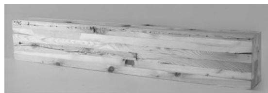
Abbildung 9: Brettschichtholzbalken, Lamellen-verbund in vertikaler und horizontaler Richtung
