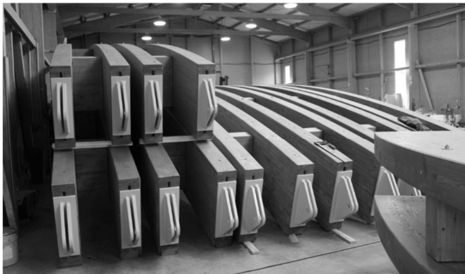
Abbildung 9: Vormontierte Bogenbinder in Doppelgebinden
