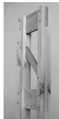
Abbildung 16: Fachwerkständer, Stäbe mit unterschiedlichen Querschnitten, zentrisch montiert
