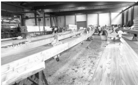
Abbildung 5: Vormontage Innenturmbinder im Werk in Kleinheubach
