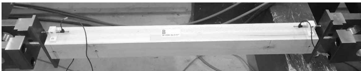
Abbildung 3: Eingespannter Prüfkörper parallel zur Faser als Zug-Zug-Versuch
