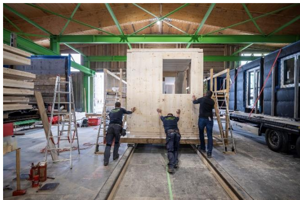
Abbildung 12: Das Schienensystem ermöglicht einen einfachen Transport der Module.
