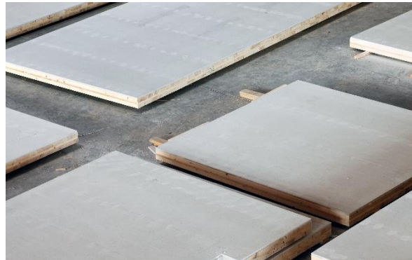
Abbildung 3: Beplankte Wände aus Kreuzlagenholz
