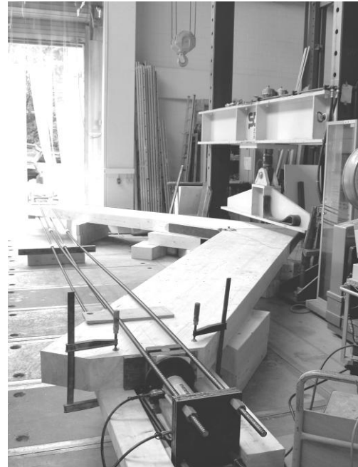
Abbildung 11: Versuchsanordnung für eine biegesteife Rahmenecke
