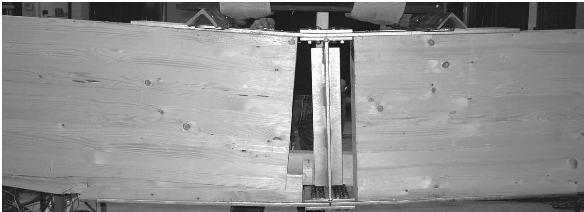
Abbildung 9: Block-Schersagen einer Holz-Stahl-Klebeverbindung im Biegezugbereich
