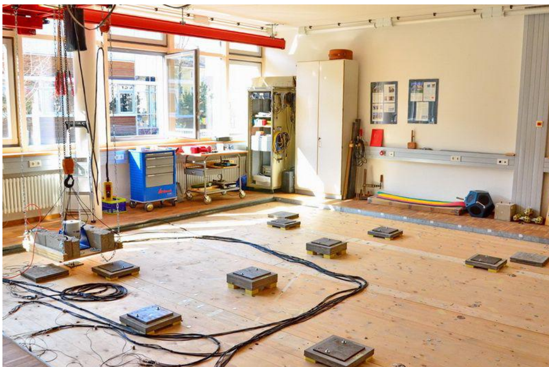
Abbildung 3: Deckenprüfstand im Labor für Schallmesstechnik LaSM; zu sehen ist eine Brettsper Holzdecke mit Schwingungstilgern zum Test, inwieweit diese das Schwingungsverhalten beeinflussen.
