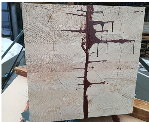
Abbildung 5: Blockverleimtes BSH aus Edelkastanie
