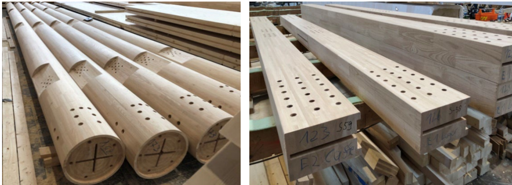
Abbildung 9 und 10: BSH Bauteile aus Edelkastanie abgebunden
