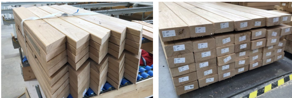
Abbildung 11 und 12: Eichenbauteile montagefertig abgebunden
