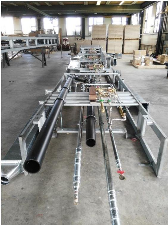
Abbildung 7: Vorfertigung der Steigzone in der Werkstatt (METHABAU, CH-8580 Amriswil)
