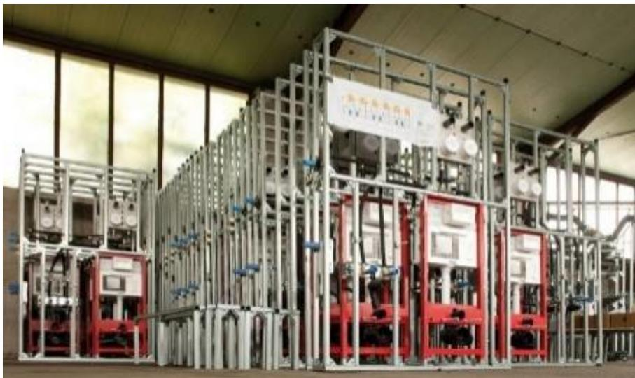
Abbildung 2: Vorgefertigte Vorwandinstallationen vor dem Abtransport (Bild: TECE Schweiz AG)
