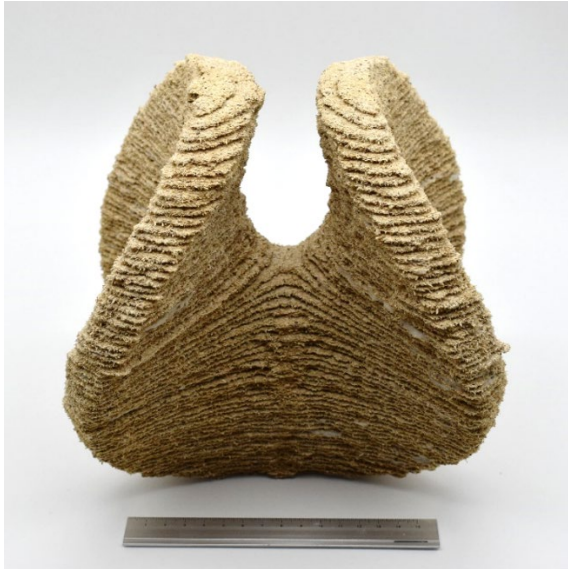
Abbildung 2: Demonstrator Objekt hergestellt mit dem ILF-Verfahren zur Veranschaulichung der geometrischen Freiheit
