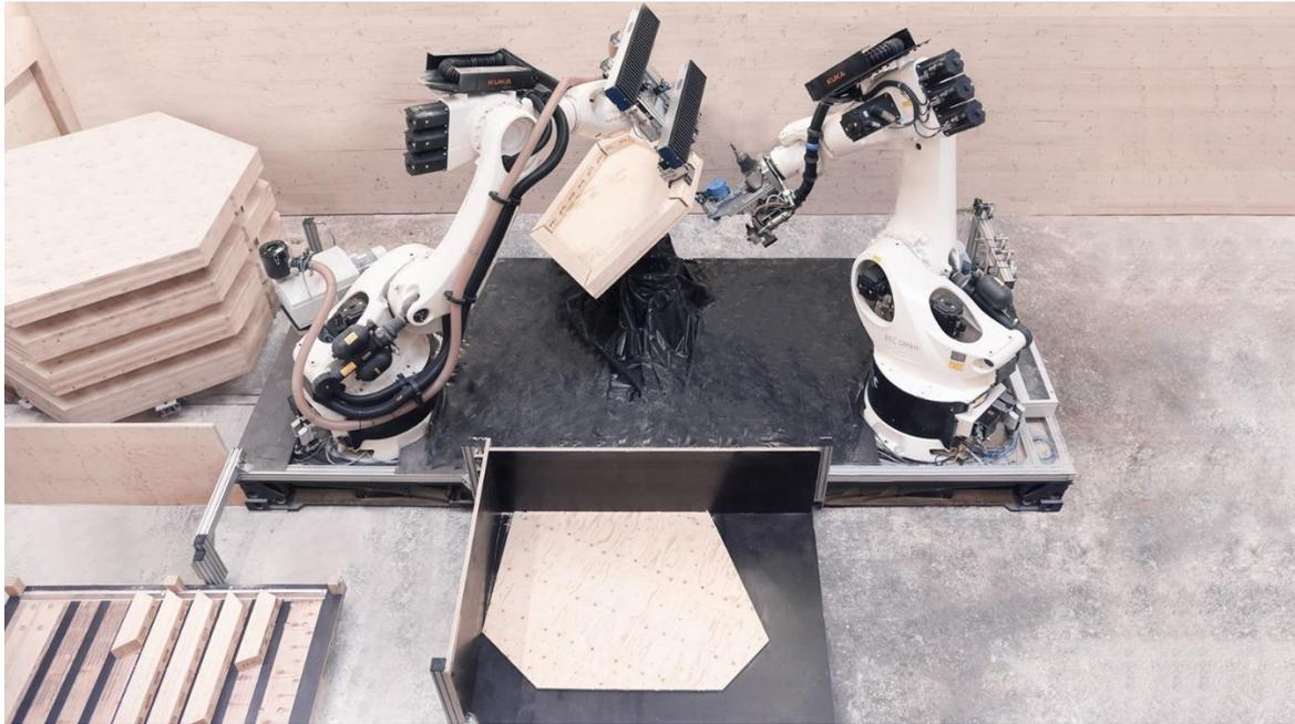
Abbildung 6: Robotische Fertigung der Kassettensegmente – Balkenelemente werden auf eine Basis-Platte geklebt und mit LignoLoc-Nägeln fixiert. Anschließend wird die Kasette mit einer Deckplatte geschlossen und in der Presse abgelegt.
