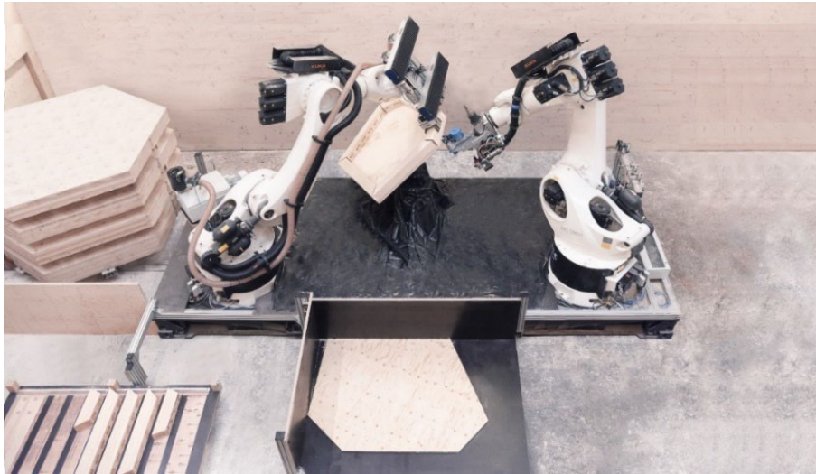
Abbildung 2: Robotische Fertigung für Kassetten BUGA Holzpavillon. Quelle: ICD/ITKE Universität Stuttgart
