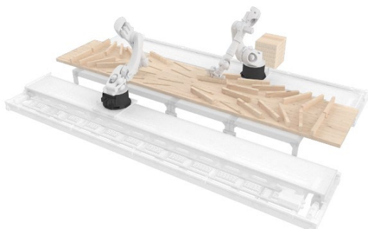
Abbildung 9: Geplante Fertigung der zweilagigen Holzdecken in der Halle des Exzellenzclusters IntCDC, Waiblingen. Quelle: IntCDC Universität Stuttgart
