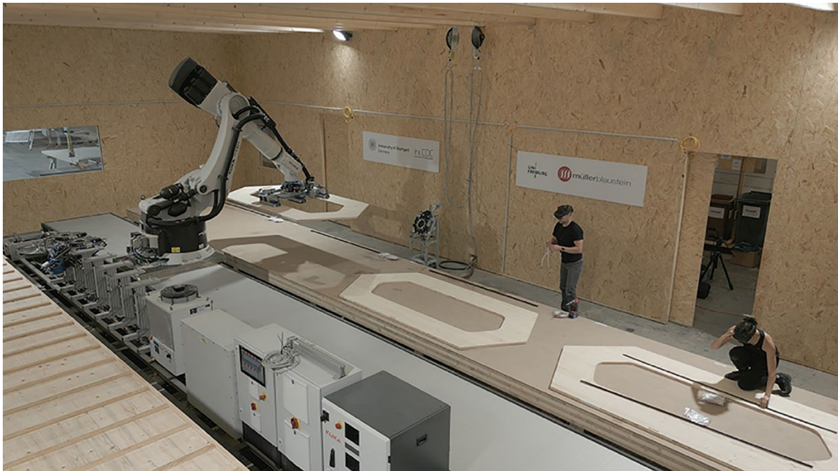
Abbildung 5: robotische Vorfertigung der Holzkassetten. Foto: ICD/ITKE/IntCDC Universität Stuttgart
