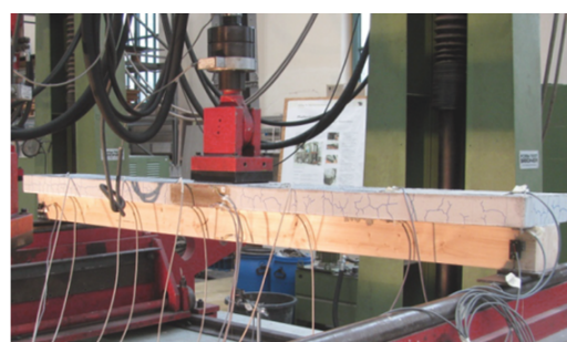
2) kurzer Biegeschub Test, l = 2,30 m
