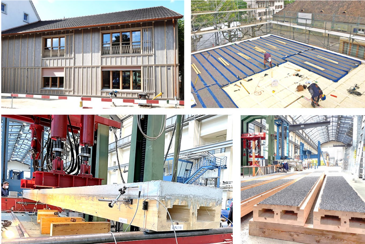
Abbildung 10: oben: Doppelkindergarten Sissach, li: Ansicht re: Holzlage der HBV-Decke ©Beer Holzbau AG unten links: Träger im Biegeversuch unten rechts: Träger mit Granulatsplitt vor dem Betonieren
