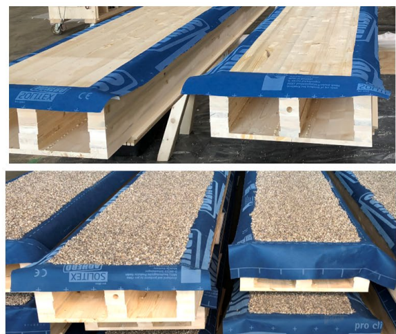
b) Holzelemente vor und nach dem Aufbringen des Granulatsplitts. © Lignotrend
