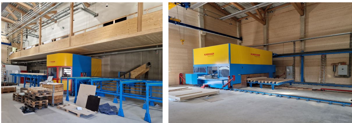
Abbildung 17: Abbundmaschinen für stabförmige Bauteile bis 9 m (links) und plattenförmige Bauteile (rechts)
