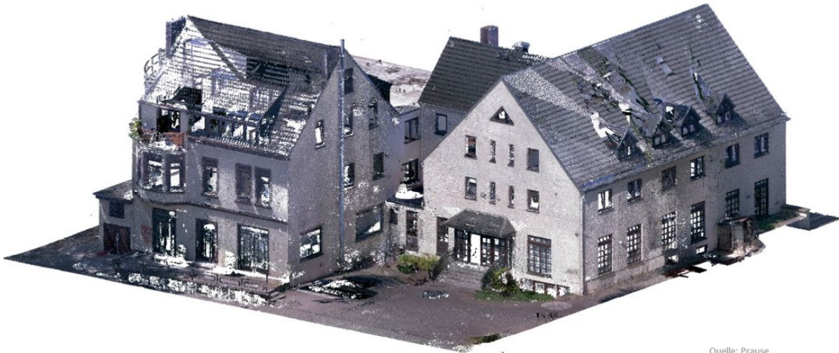
Abbildung 2: An 42 Laserscanner-Standorten 470549.396 Scannerpunkte aufgenommen. Quelle: Prause
