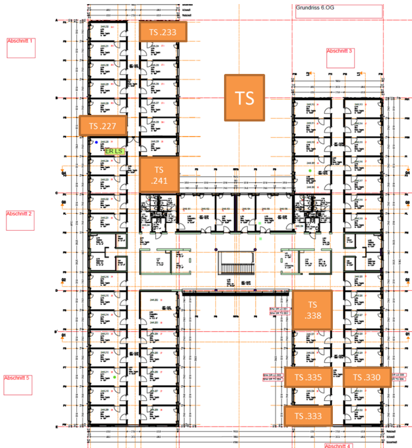
Abbildung 10: Positionen der Trittschallmessungen ©Kaufmann Bausysteme GmbH
