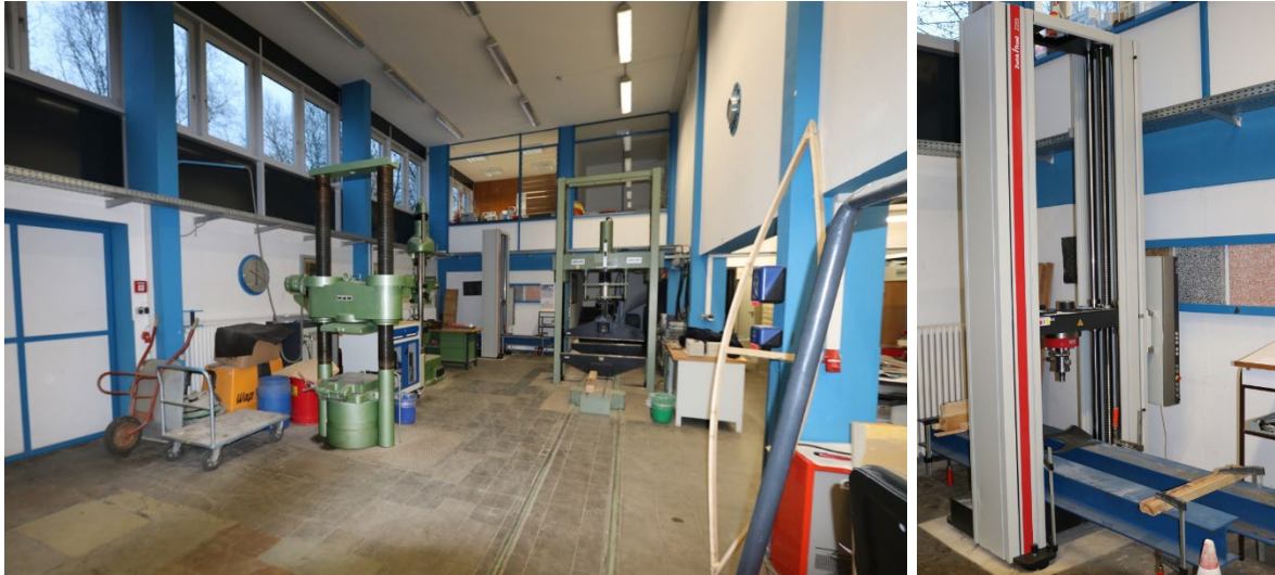
Abbildung 2: Prüfhalle des Baustoff- und Holzbaulabors am IBB (links), Universalprüfmaschine 250 kN (rechts)
