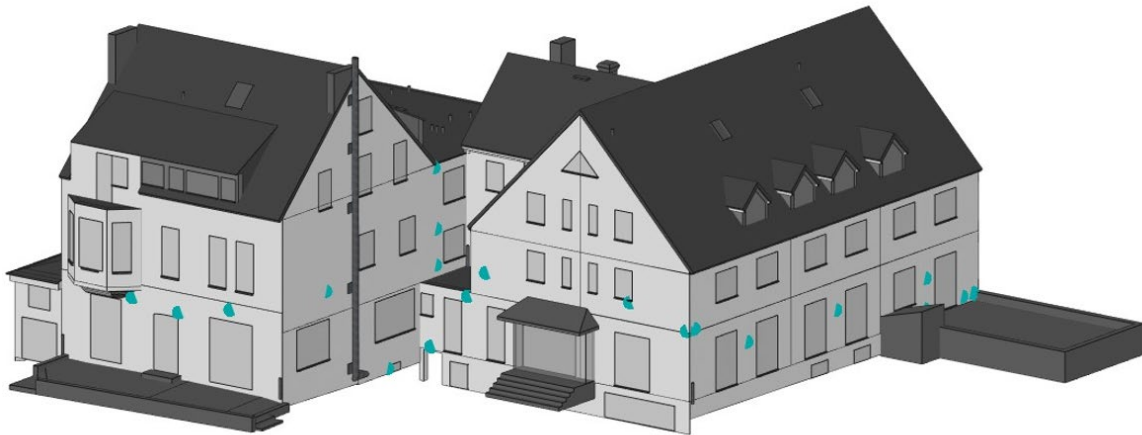
Abbildung 3: Modell des Aufmaßes für Entwurf, Statik, Wärmeschutz, Arbeitsvorbereitung. Quelle Prause
