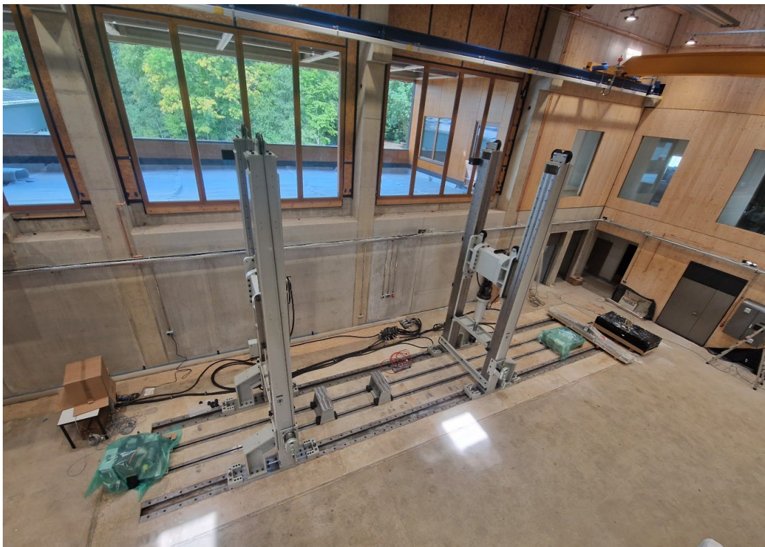
Abbildung 14: Biegeprüfmaschine 2 x 600 kN, erweiterbar auf 4 x 600 kN, für Spannweiten bis zu 15 m
