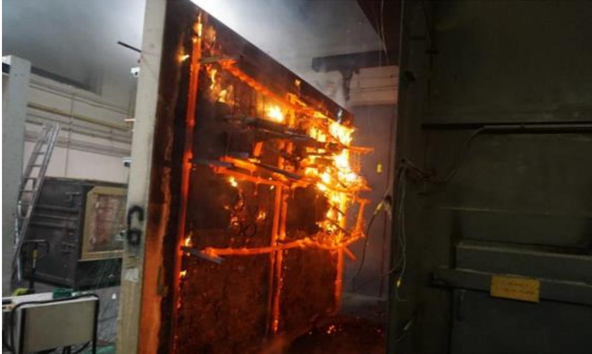
Abbildung 9: Geöffneter Ofen nach Abschluss einer Feuerwiderstandsprüfung am Institut für Brandschutztechnik und Sicherheitsforschung in Linz, Österreich
