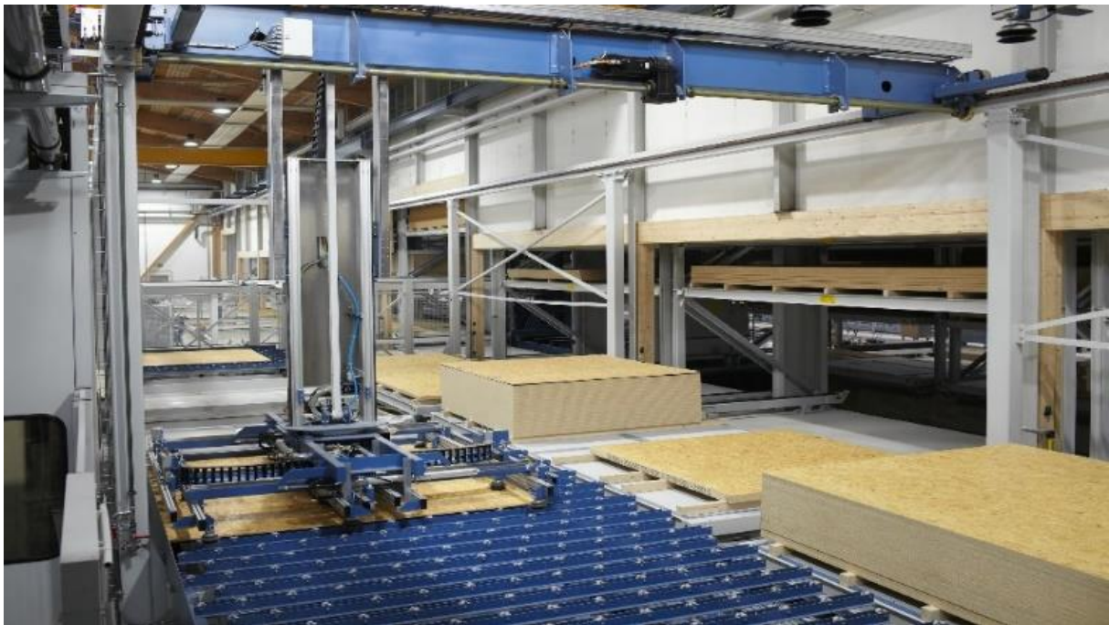
Abbildung 18: Portalladesystem, automatische Beschickung des Bearbeitungszentrums
