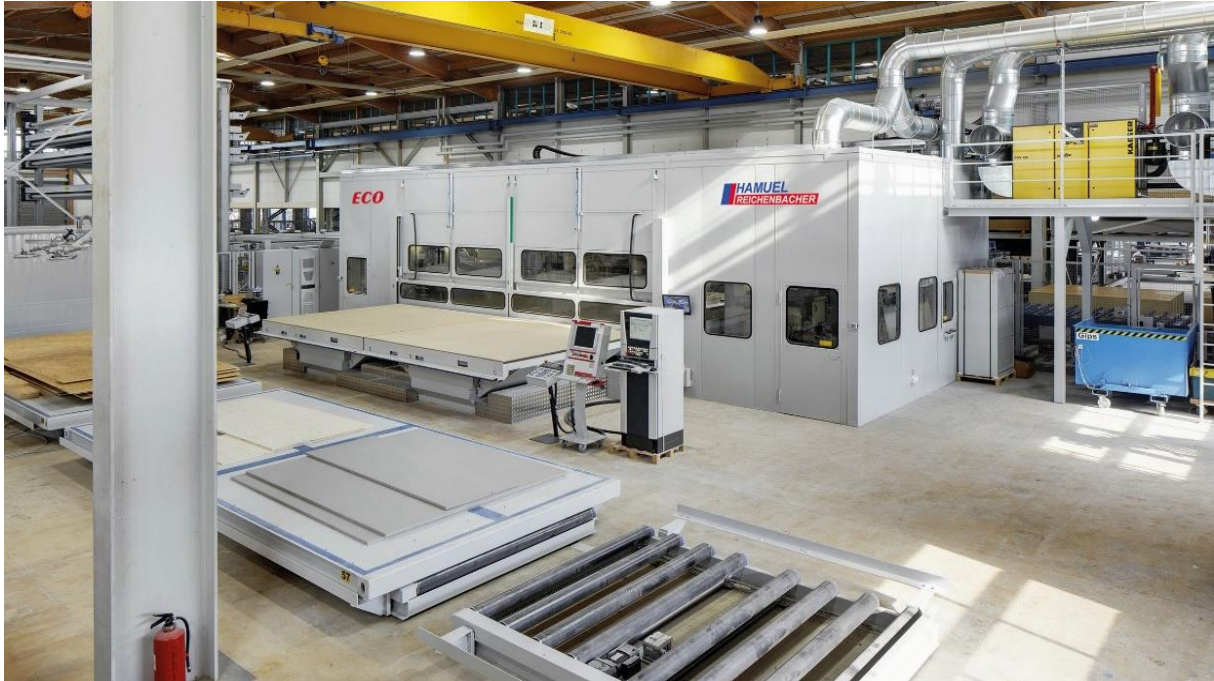
Abbildung 17: CNC-Plattenbearbeitungszentrum mit Kommissionier-Paletten
