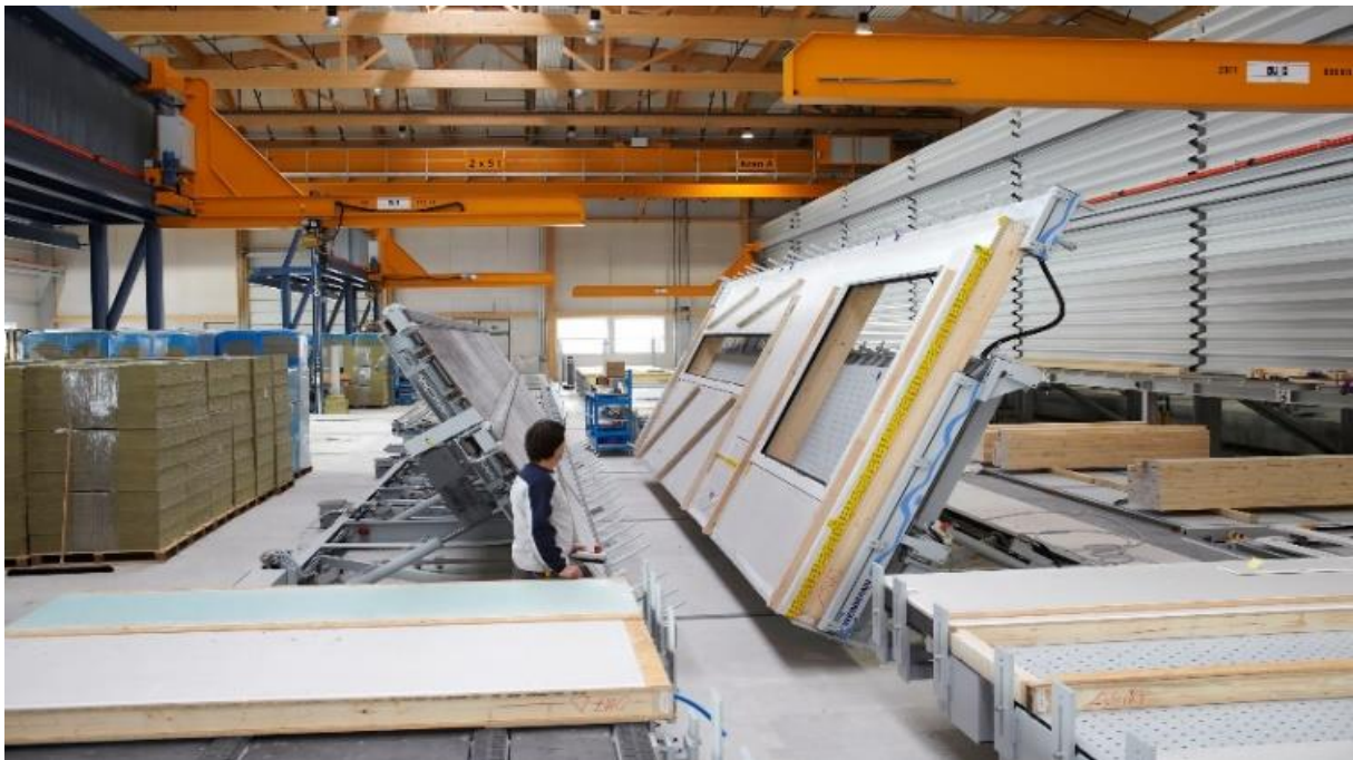
Abbildung 20: Montagelinie für Wandmodule mit Schmetterlingstische und Fertigteilbereitstellung
