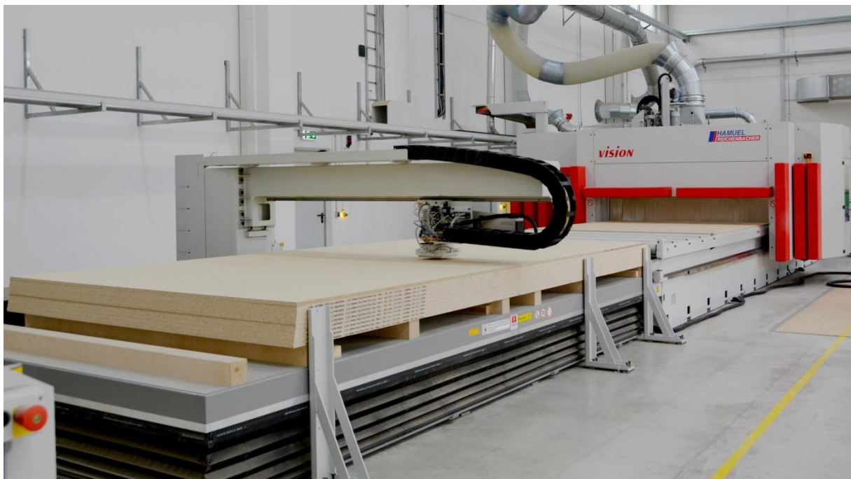
Abbildung 12: Anlage mit Roh- und Fertigteilhandling sowie externem Beschriftungsroboter
