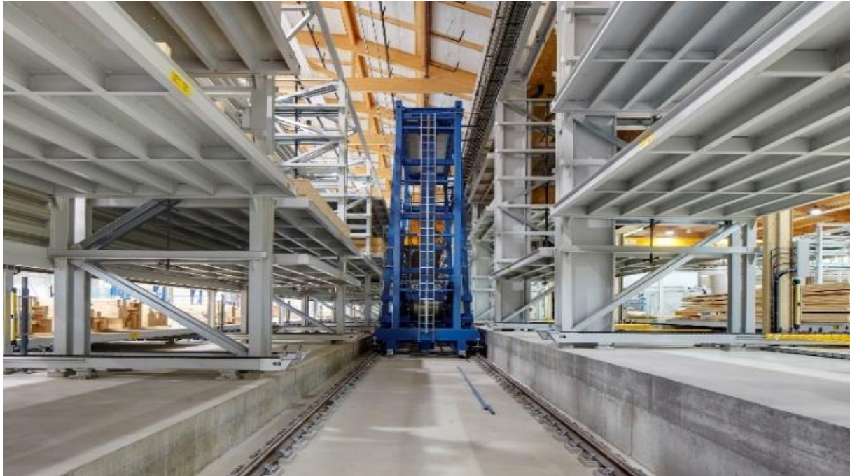
Abbildung 19: Hochregalbediengerät mit Paletten-Bereitstellung für Fertigungsline und Montagelinie, Traglast ca. 6 t
