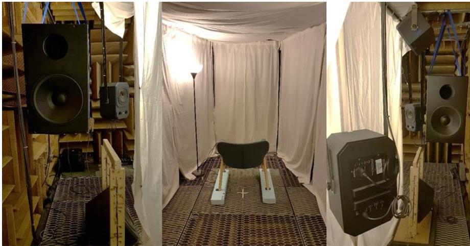
Abbildung 10: Lautsprecheraufbau für den Hörversuch
