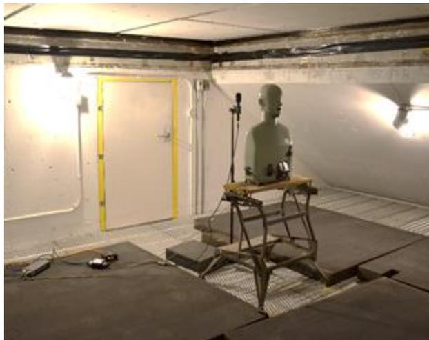
Abbildung 8: Deckenprüfstand am NRC: Anordnung der Hallräume (links) und Aufbau zur Aufnahme für die subjektive Studie im unteren Hallraum (rechts)
