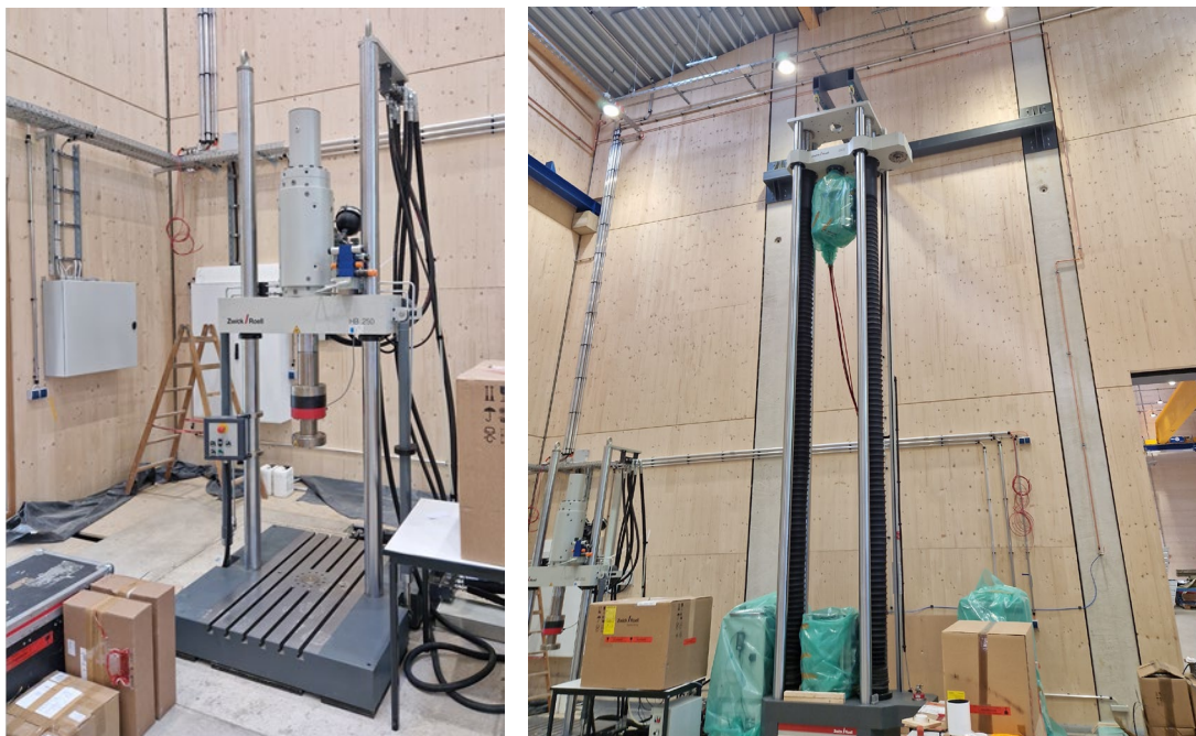
Abbildung 16: Prüfmaschine für statische und dynamische Wechselbeanspruchungen (links) mit 250 kN Höchstlast und Universalprüfmaschine 600 kN (rechts) mit 6 m Prüfraumhöhe und hydraulischen Spannbacken
