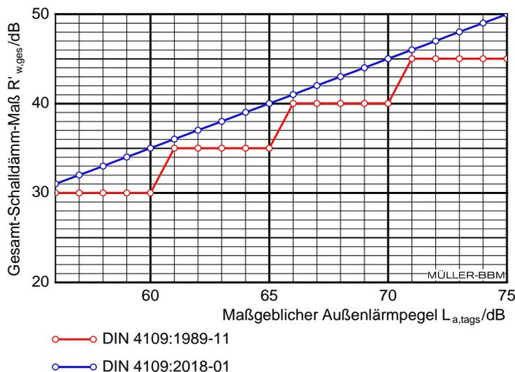
Abbildung 5: Schienenverkehrslärm,  $\Delta L_{Tag/Nacht} = 0$  dB, d.h. gleicher Pegel am Tag und in der Nacht
