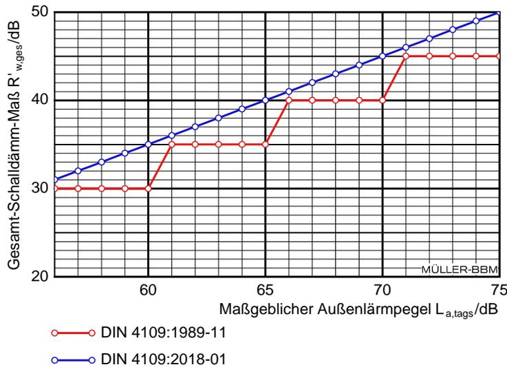
Abbildung 4: Straßenverkehrslärm an einer Autobahn,  $\Delta L_{Tag/Nacht} = 5$  dB (Verkehrbelastung in der Nacht 32% vom Tagwert)
