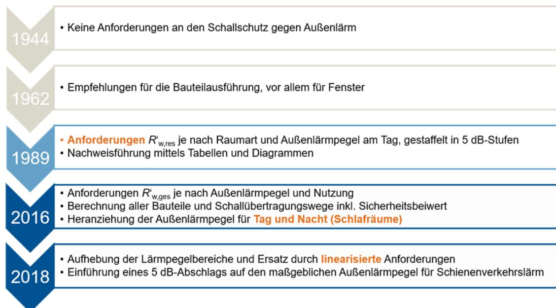
Abbildung 2: Neuerungen der verabschiedeten Fassungen der DIN 4109 zum Schallschutz gegen Außenlärm
