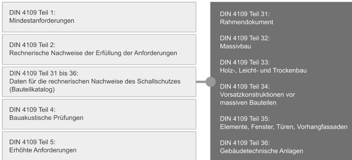
Abbildung 1: Struktur der neuen Schallschutznorm für den Hochbau DIN 4109:2018-01
