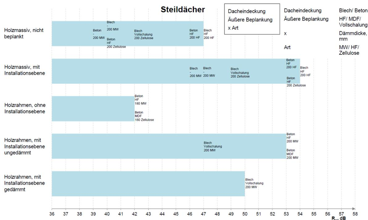
Abbildung 9: Zusammenstellung von Steildächern aus der Datenbank Dataholz.eu [10]
