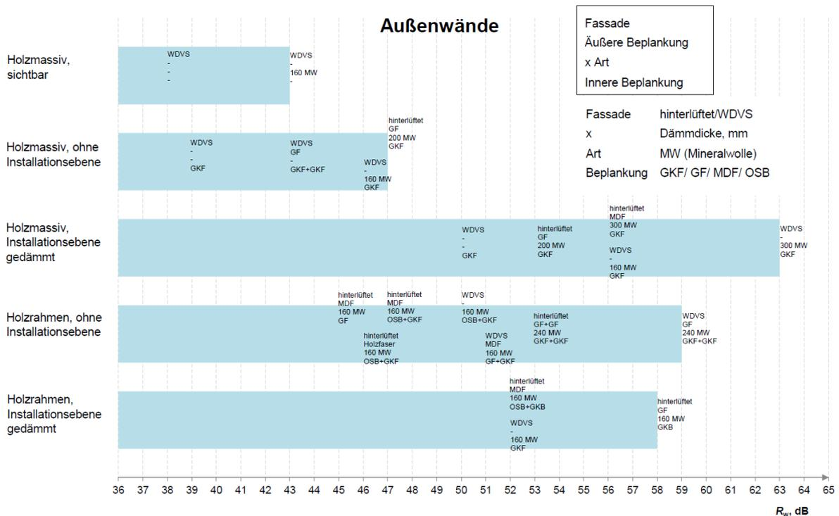
Abbildung 8: Zusammenstellung von Außenwänden aus der Datenbank Dataholz.eu [10]
