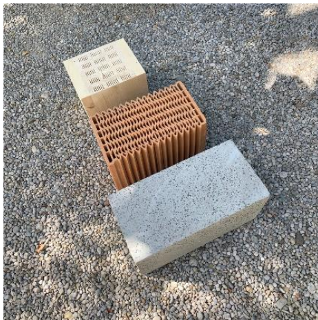
Abbildung 6: Die drei verwendeten Außenwandmaterialien: Massivholz und Ziegel - jeweils mit Luftkammern, sowie Infralichtbeton. Foto: Tilmann Jarmer
