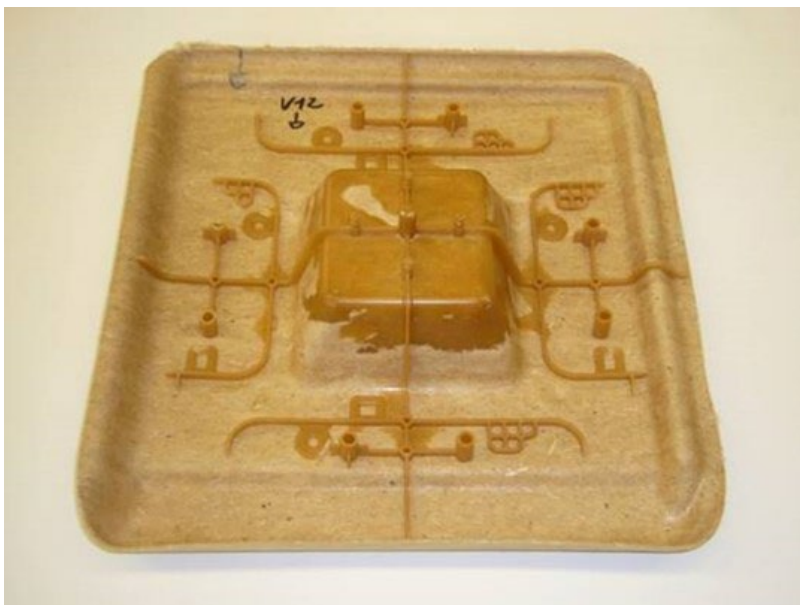
Abbildung 7: Unbeschichtetes Testbauteil aus konsolidiertem Holzfaservliesstoff mit angespritzten Strukturen (Versuche mit Industriepartnern u. a. AUTEFA, ANDRITZ Fiedler, FRIMO)
