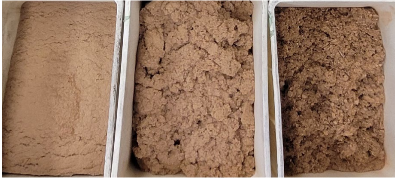
Abbildung 4: Fraktionierte, aus Altmöbeln und Laminatfußboden wiedergewonnene Fasern nach Abscheidung von Störstoffen.
