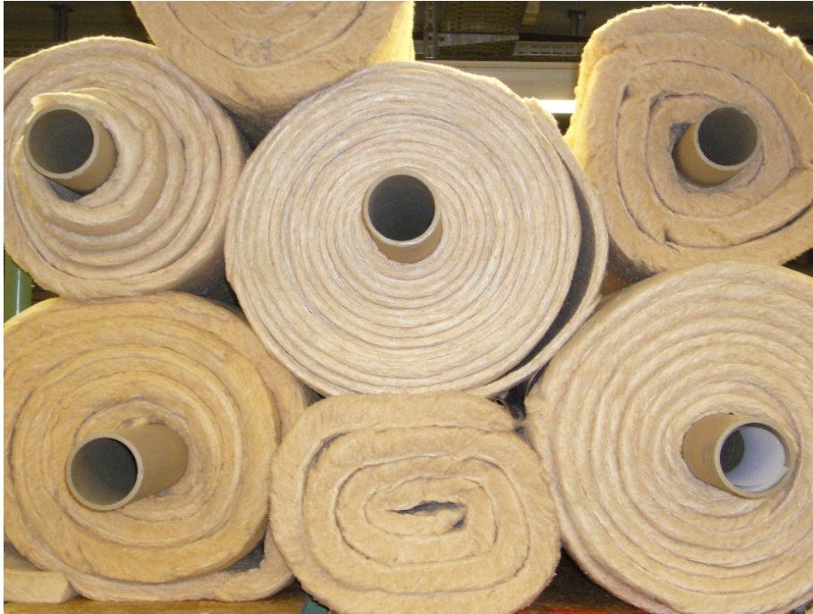
Abbildung 6: Erste hergestellte holzfaserbasierte Vliesstoffe.
