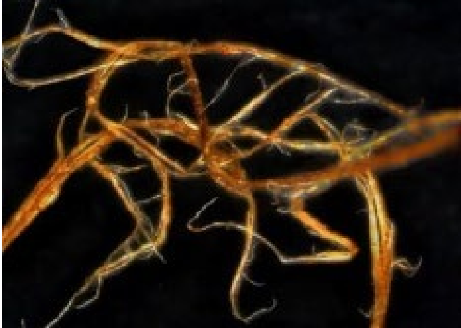
Abbildung 1: Fasern aus Eukalyptusrinde nach mechanischer Zerkleinerung ohne Druckbeaufschlagung. Aus Eukalyptusrinde lassen sich sehr stark verzweigte Fasern herstellen, die sich sehr gut auch ohne Bindemittel verarbeiten lassen.
