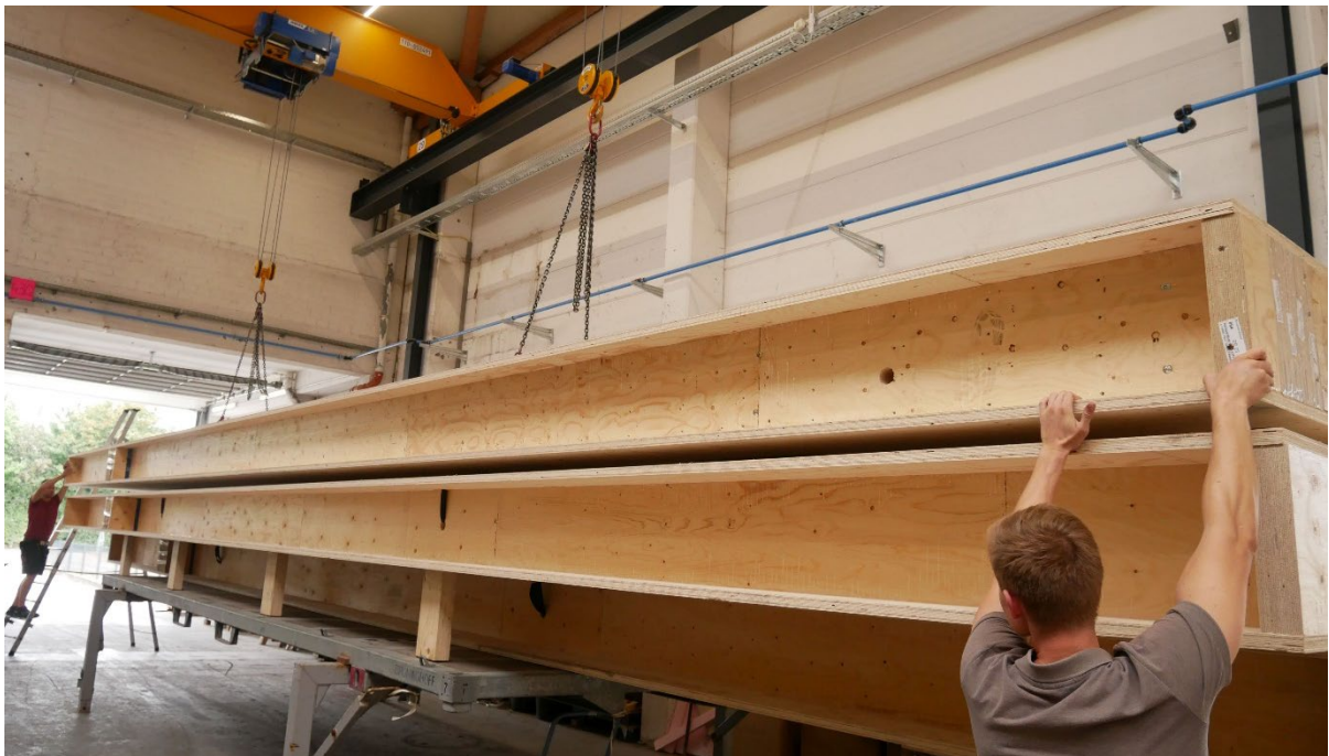
Abbildung 1: Kastenelemente mit 14 m Länge (Bildquelle: Brüninghoff Group)
