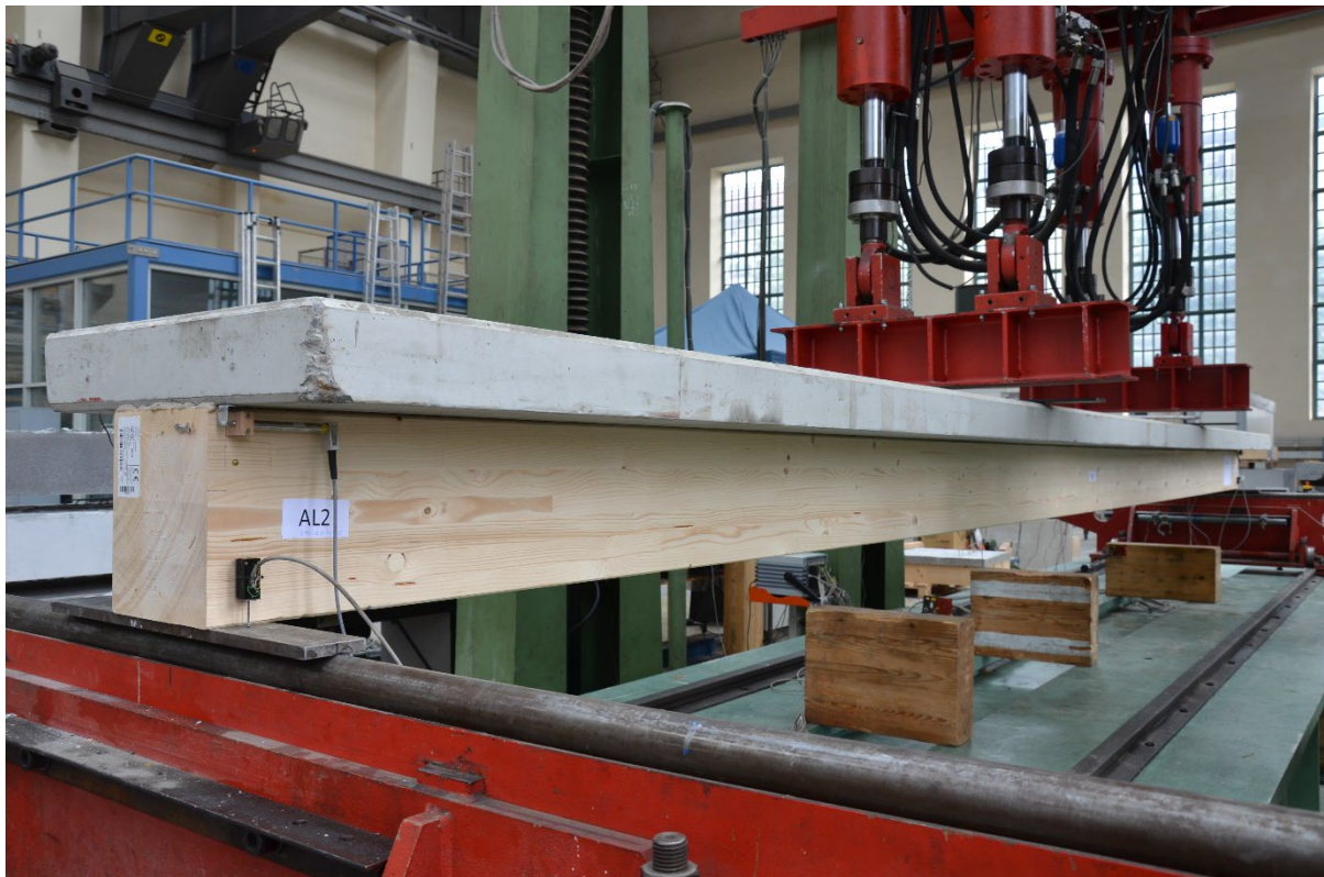
Abbildung 6: Geklebter HBF-Prüfkörper mit 8,1 m Länge in der Prüfmaschine für den 4-Punkt-Biegeversuch (Bildquelle: TU Berlin)
