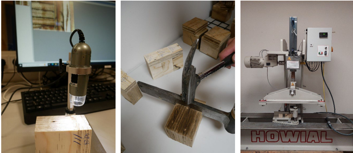
Abbildung 3: Qualitätssicherung – Messung der Klebstofffugendicke, Aufstechprüfung nach Kochwechselbehandlung, Ermittlung der Scherfestigkeit (Bildquelle: Brüninghoff Group)
