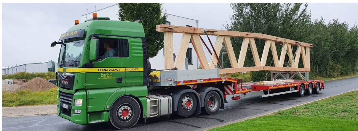
Abbildung 10: Demonstrator des entwickelten Trägers mit 16 m Länge (Bildquelle: Brüninghoff)
