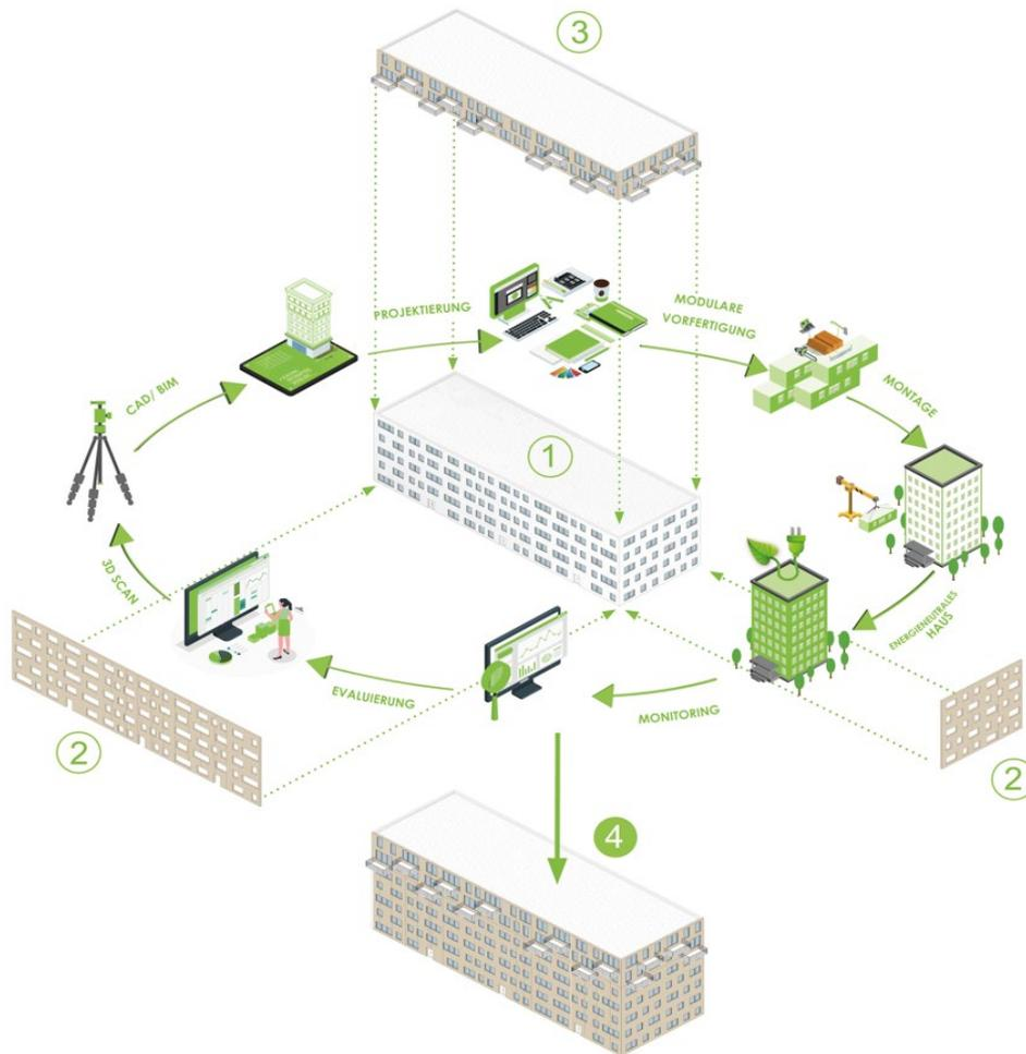
Abbildung 5: Ablauf einer Aufstockung in modularer Bauweise mit energetischer Sanierung der Fassade
