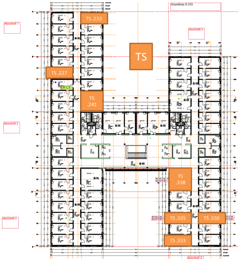
Abbildung 10: Positionen der Trittschallmessungen ©Kaufmann Bausysteme GmbH
