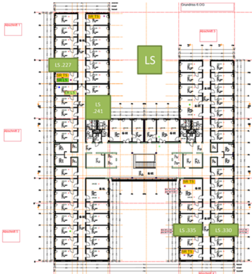
Abbildung 11: Positionen der Luftschallmessungen ©Kaufmann Bausysteme GmbH
