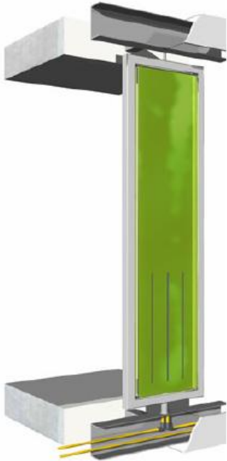
Abbildung 9: Fassade als Bioreaktor ©Colt International 6
