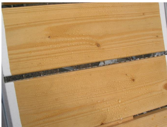
Abbildung 11: Hydrophobierte Holzproben auf dem Bewitterungsstand, ein Abperleffekt ist erkennbar, welcher jedoch zeitlich begrenzt ist (Volkmer 2008)
