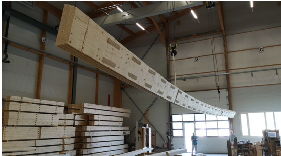
Abbildung 4 und 5: statische Mock-ups mit maximaler Torsion und maximaler Biegung (Blumer-Lehmann AG)
