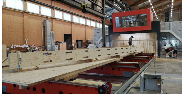
Abbildung 4 und 5: statische Mock-ups mit maximaler Torsion und maximaler Biegung (Blumer-Lehmann AG)
