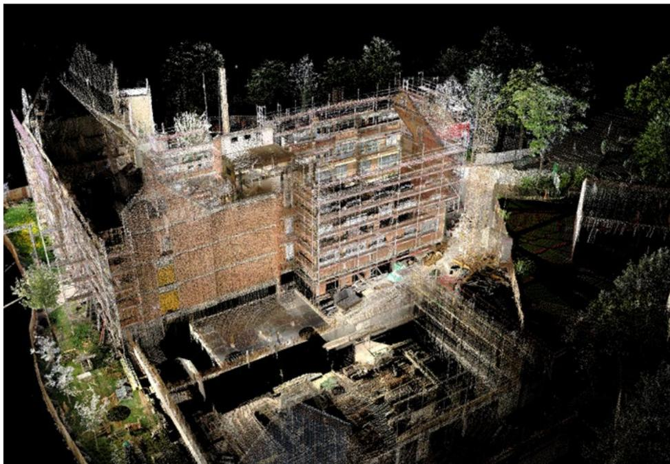
Abbildung 6: Digitales Gebäudeaufmaß mit 3D Laserscan
