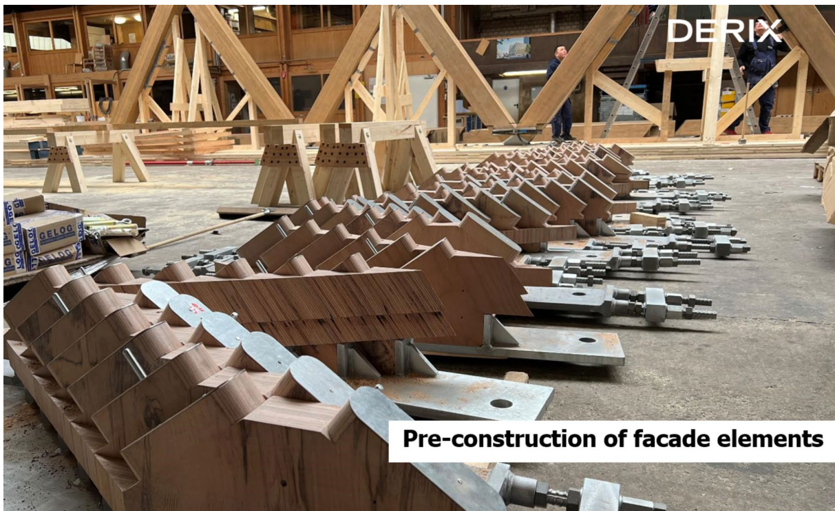
Abbildung 5: Vorfertigung im Werk (DERIX Gruppe)
