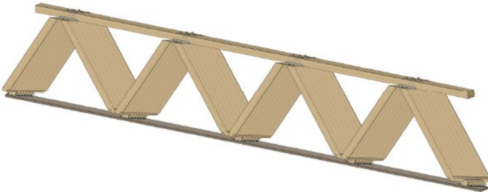
Abbildung 7: Vorelementierte Fassadenstützreihe (DERIX Gruppe)
