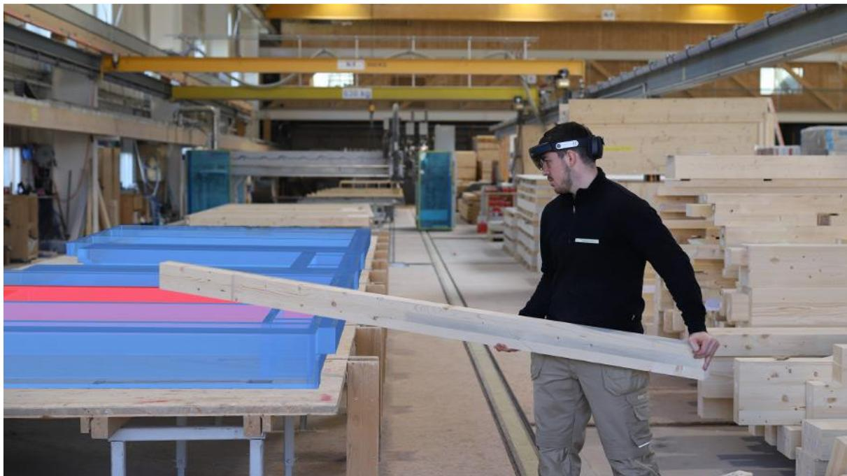
Abbildung 1: Element Hologram in der Produktion von schauerholzbau (Quelle afca)
