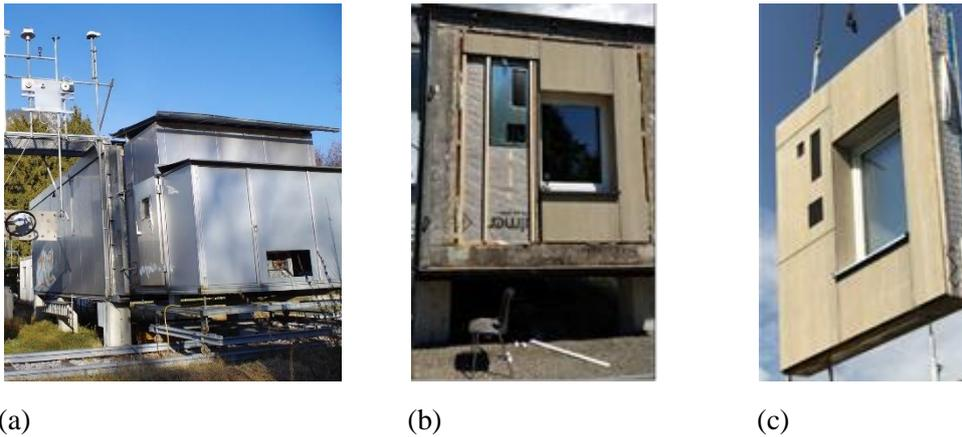
Abbildung 6: PASSYS-Testzelle mit «Coldbox» (a) und Mock-Up eines vorgefertigten Holzfassadenelements mit integriertem Außengerät der Heizungs-Lüftungs-Wärmepumpe in der PASSYS-Testzelle der UIBK (b) Montage des Fassadenelements (c) (Ausführung: Holzbau Kulmer, Österreich); FFG Projekt SaLüH! / Kulmer
