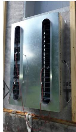
Mock-up eines Fassadenelements für serielle Sanierung in der PASSSYS Testzelle (UIBK)
