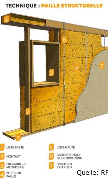
Bild 11: lastabtragende Strohballen (die aufeinandergeschichteten Ballen werden mit Baumbusstangen, Zugbändern o.ä. miteinander verspannt – diese Bauweise ist in Deutschland nicht allgemein zugelassen)
