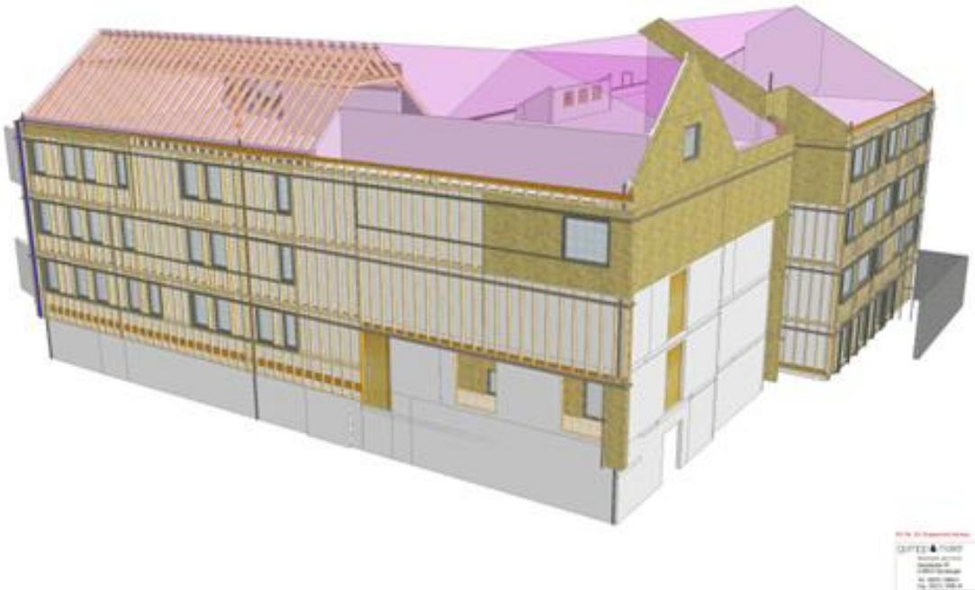
Abbildung 4: CAD/CAM Holzbauplanung der Fassadenelemente auf Basis der Punktfolge des Laserscans
