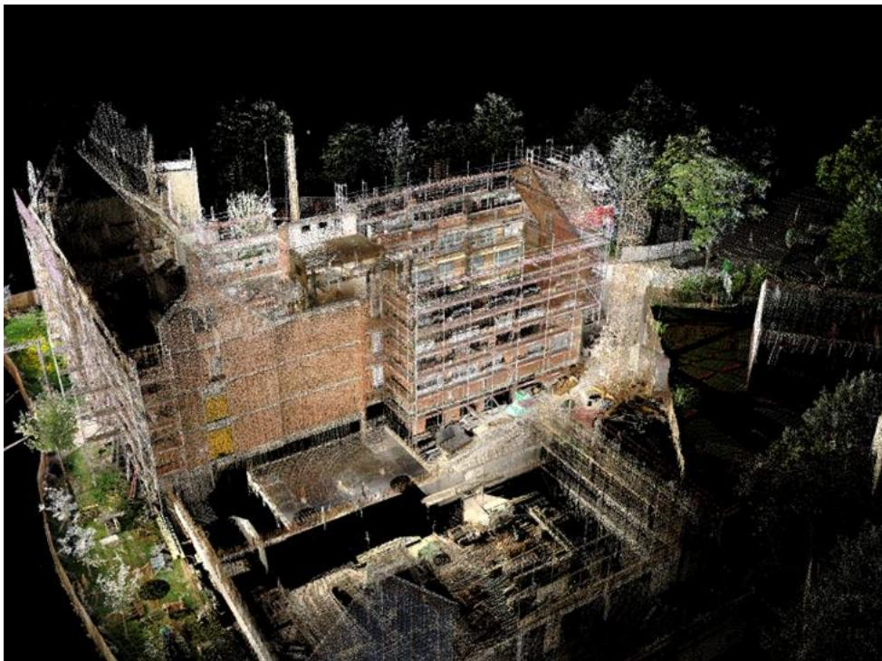
Abbildung 6: Digitales Gebäudeaufmaß mit 3D Laserscan
