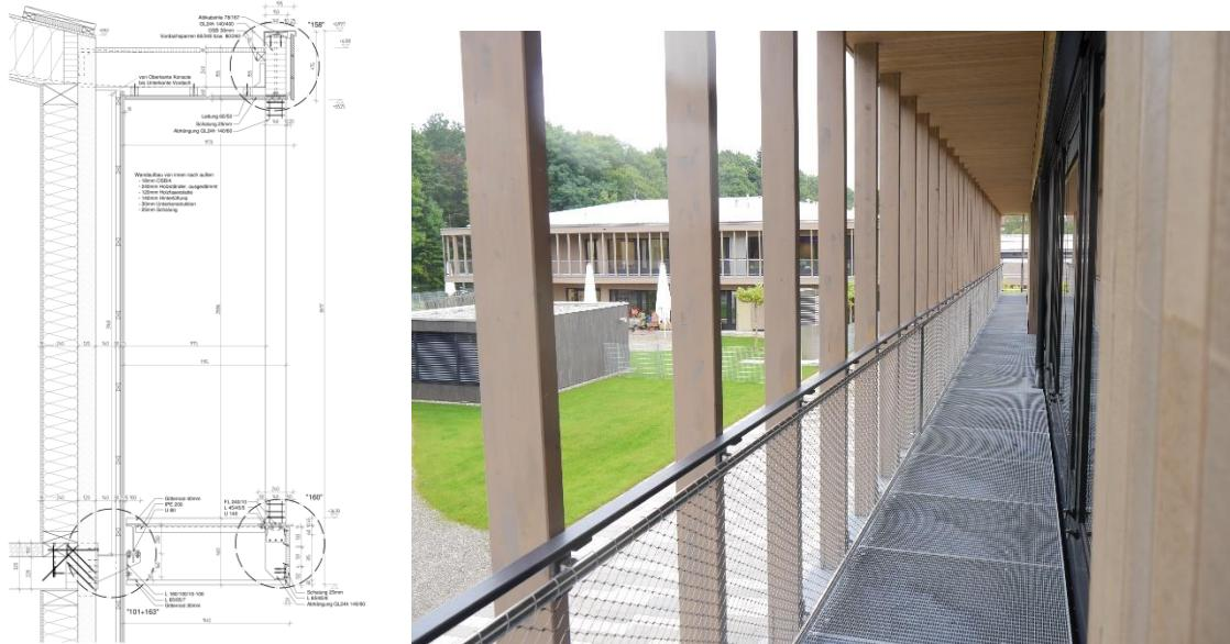
Abbildung 6: Abgehängte Balkonkonstruktion – Grundschule Pullach
