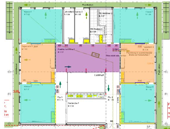
Eine attraktive Alternative stellt deshalb die abgehängte Fluchtbalkon-Variante dar. Dabei können die Balkonplatten an der Fassade über Konsolen thermisch entkoppelt auf den Außenwänden angelegt werden und von außen über Zugstäbe an die Dachkonstruktion hochgehängt werden. Statisch gesehen verursacht diese gängige Variante keinen großen Aufwand und ermöglicht den Gebäudenutzern einen freien erdgeschossigen Ausgang.
