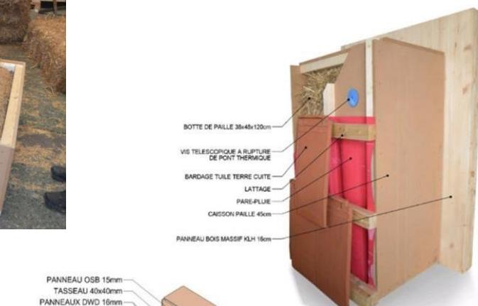
Bild 29: Detail zum Wandaufbau
