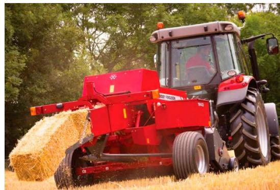
Bild 5: Ballenpresse für Kleinballen
