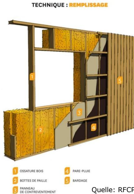
Bild 8: Vorfertigung (die Strohballen werden in Kastenelementen vorgefertigt, die auf der Baustelle zusammengesetzt werden)
