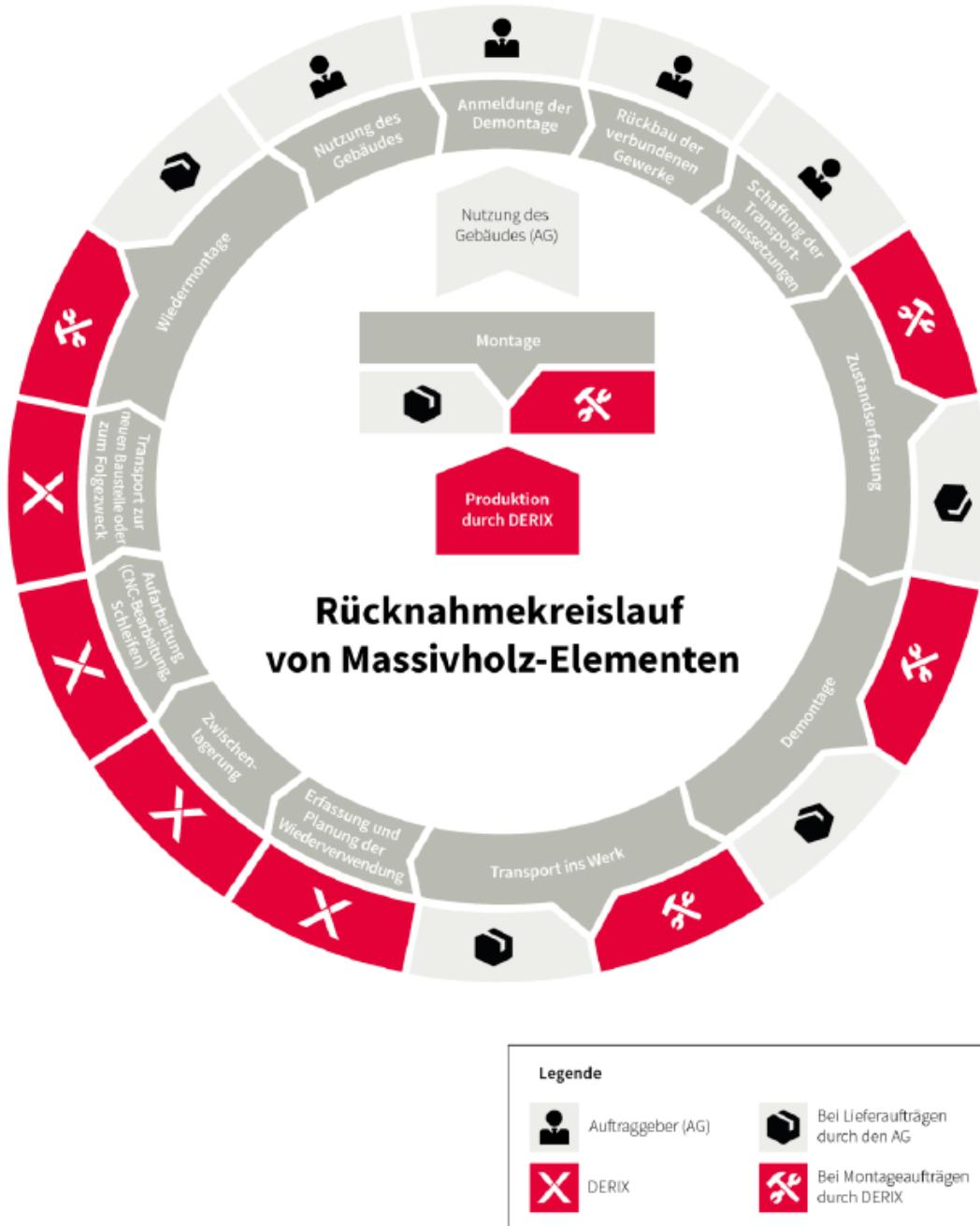
Abbildung 1: Rücknahmekreislauf von Massivholzelementen bei der DERIX Gruppe
