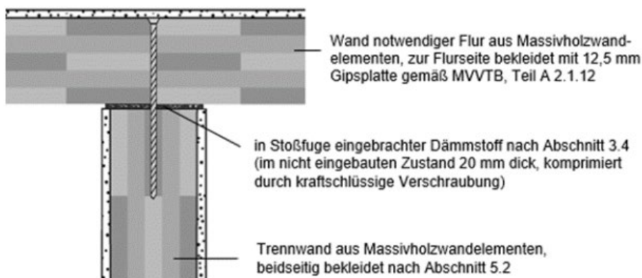
Prinzipskizze 8b: Anschluss Trennwand / Wand notwendiger Flur, Bauteilfuge (Horizontal)
