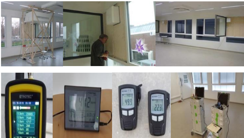
Abbildung 5: Test mit 3 unterschiedlich großen dezentralen Lüftungsanlagen im gleichen Klassenraum. Von links – Sensormessgeräte für Partikel, CO 2 , Feuchte/Temperatur, VOC Raumluftanalyse/Pumpenausrüstung.
