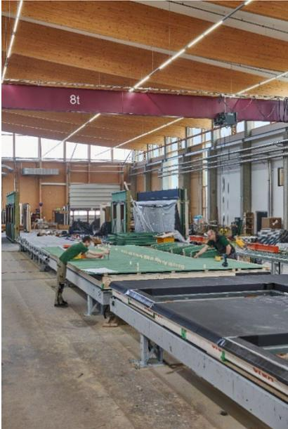
Abbildung 4: Vorproduktion der Wände – mit Fenstern und Fassade
