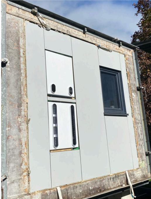
Abbildung 5: Testfassade (Kulmer Holzbau) in der PASSYS Testzelle der UIBK mit Wärmepumpenaußeneinheit (unten) und Lüftungsgerät mit Wärmerückgewinnung (oben). Testfassade: Kulmer Holzbau; Wärmepumpe und Lüftungsgerät: Drexel und Weiss
