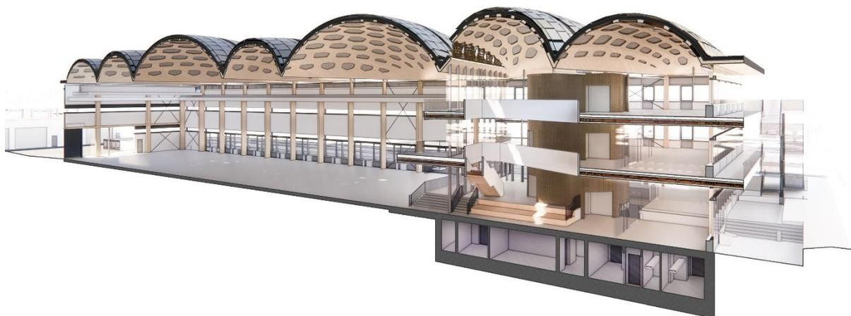
Bild 5: Large Scale Robotic Construction Laboratory des IntCDC auf dem Campus Vaihingen der Universität Stuttgart, Fertigstellung 2026. Quelle: IntCDC Universität Stuttgart
