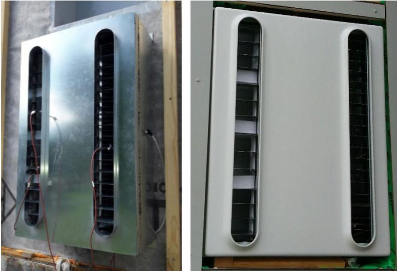
Abbildung 6: Funktionsmuster der fassadenintegrierten Außeneinheit für Labormessung (links) und Prototyp (Drexel und Weiss) im Mock-up (Testfassade) für die serielle Sanierung in der PASSYS Testzelle (UIBK)
