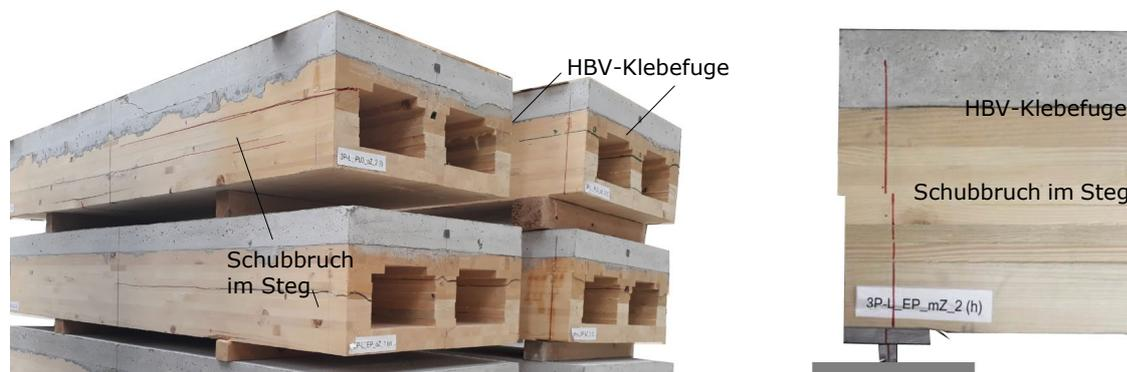
Abbildung 12: Kurze, gedrungene Lignotrend-HBV-Träger nach den Drei-Punkt Biegeschubversuchen zum Test der Schubtragfähigkeit: Immer Schubversagen im Holz der Stege
