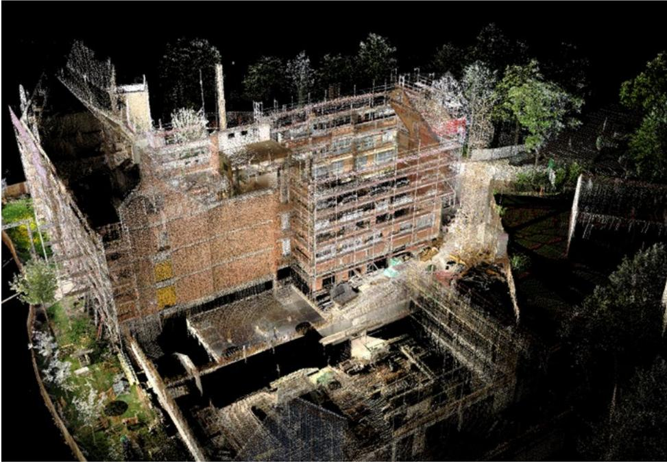
Abbildung 6: Digitales Gebäudeaufmaß mit 3D Laserscan
