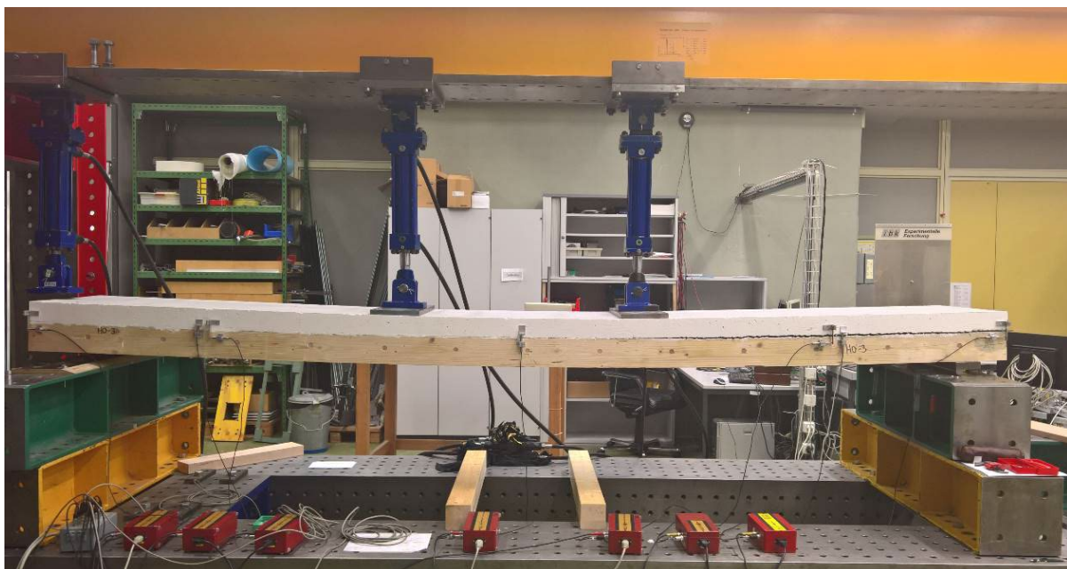
Abbildung 8: Vier-Punkt Biegeversuch mit Holz-Beton-Verbunddeckenelementen mit Mikrokerneln
