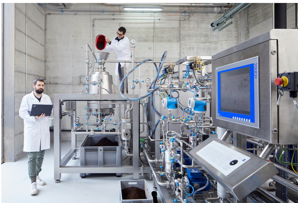
Abbildung 1: Pilotextraktionsanlage zur Erzeugung tanninreicher Extrakte aus Holz und Rinde heimischer Baumarten an der Berner Fachhochschule, Biel
