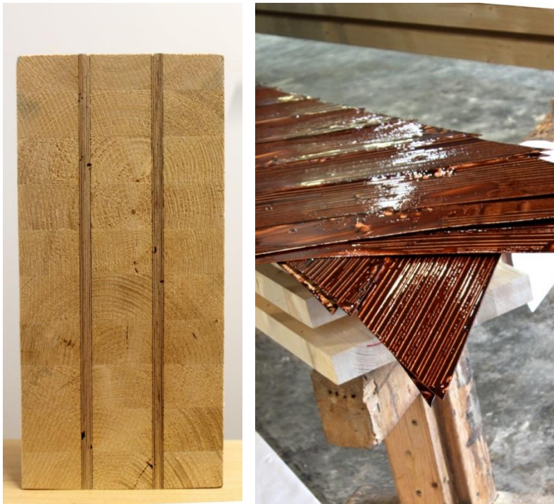
Abbildung 1: «Holzbewehrtes Holz» – Brettschichtholz mit schräg verlaufenden, innenliegenden Buchenholzurnieren
