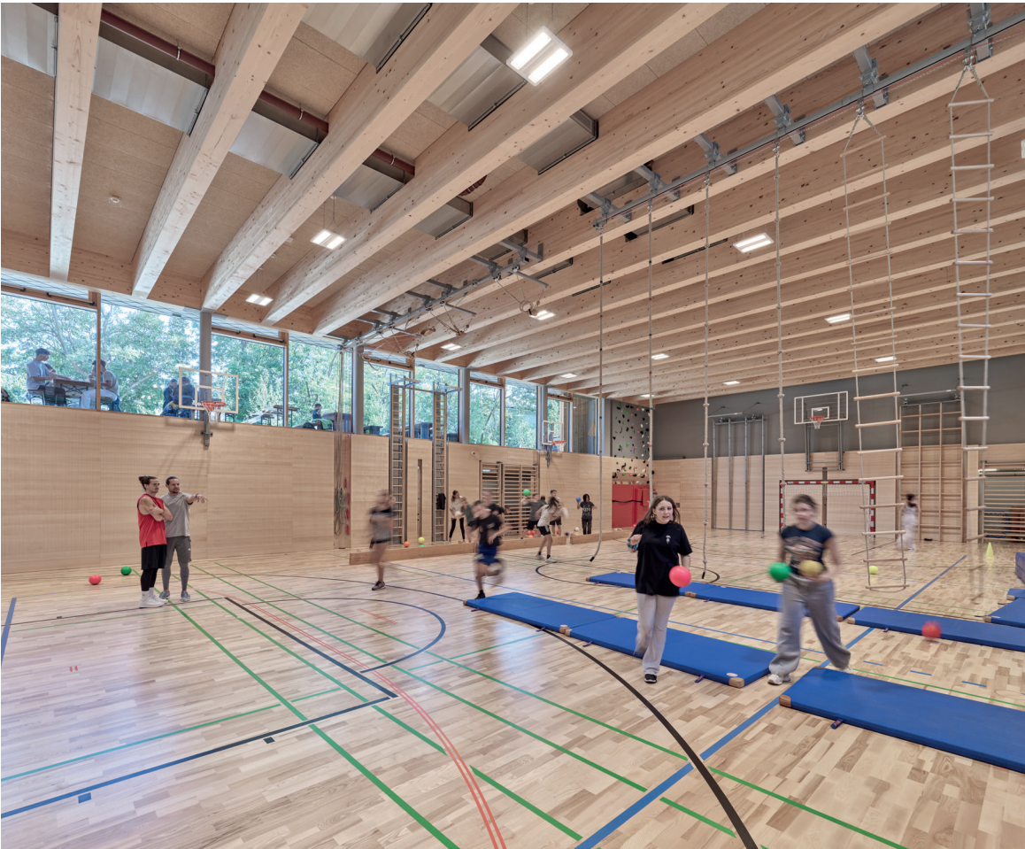
Die neue Turnhalle liegt zur Hälfte unter der Erde, der Aushub kam beim Innenausbau in Form von Lehmoberflächen zum Einsatz.
