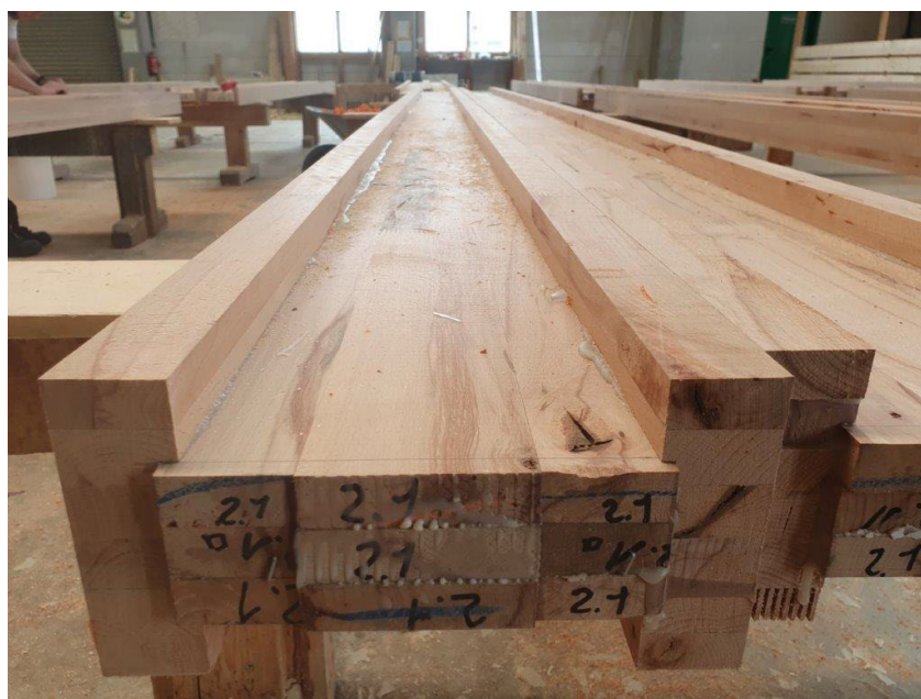
Abbildung 4: I-förmige Dachträger aus Buchenholz niedriger Qualität aus dem Stamminneren [12]. Quelle: Schaffitzel Holzindustrie GmbH + Co. KG
