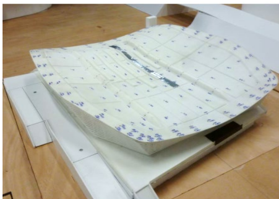
Abbildung 6: Modell für den Windkanalversuch
