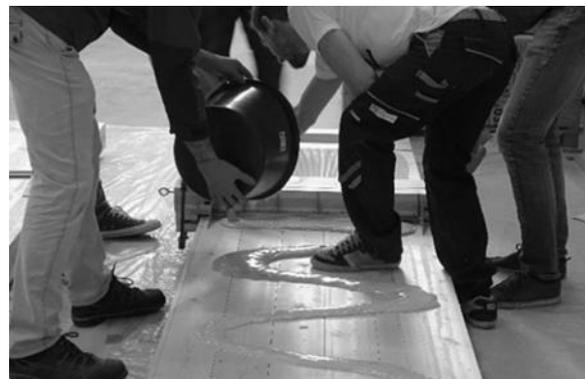
b) Grober Klebstoffauftrag vor der halbautomatischen Klebstoffapplikationsmaschine
