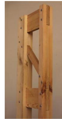
Abbildung 15: Fachwerkständer, Stäbe mit unterschiedlichen Querschnitten, zentrisch montiert
