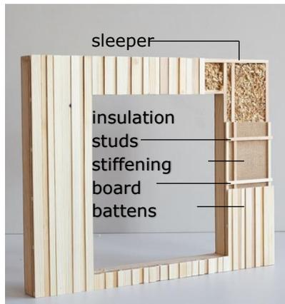
Abbildung 9: Design Konzept für Fassadenelement, Model: M. 1:20
