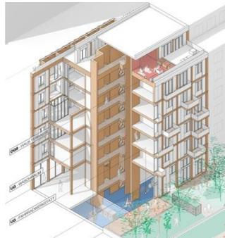
Abbildung 24: Skelettkonstruktion mit aussteifendem
